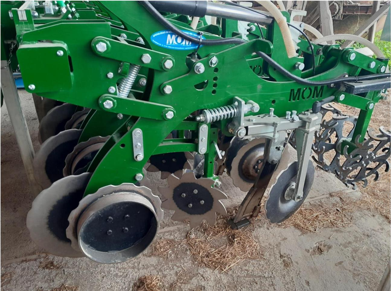
Foto 1: Strip Till Gerät zur streifenweisen Lockerung
