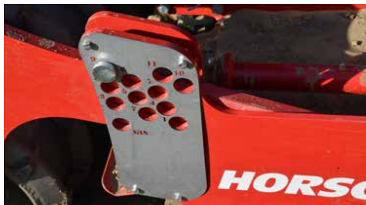
Die Arbeitstiefe der Kreiselegge ist mittels Lochkullisse mit zwölf Positionen einzustellen – die Kennzeichnung ist vorbildlich.
