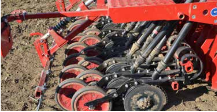
Die Scharanlenkung bewirkt, dass das Schar bei höherem Druck seitlich ausweicht oder geringfügig kippt.
