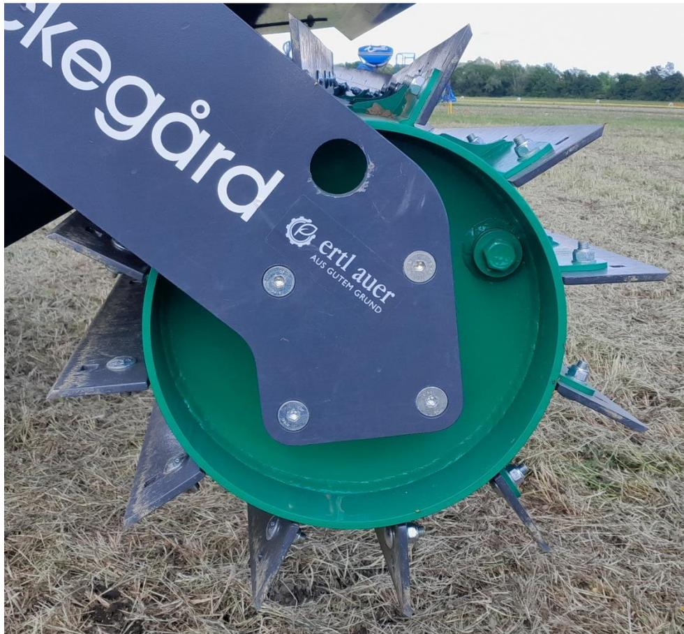
Wendbares Messer mit scharfer und stumpfer Kante, Öffnung zur Wasserfüllung bzw. Entleerung
