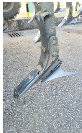
Hartmetallbestückte Schare lindern die Verschleißproblematik stark.
