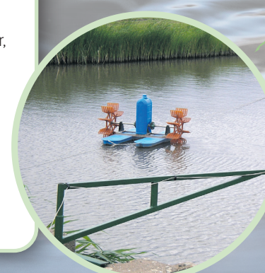
Schaufelradbelüfter sind eine der vielen Möglichkeiten, um den Teich mit Luftsauerstoff anzureichern. Bei sehr hohen Lufttemperaturen kann allerdings auch die Wassertemperatur durch den Einsatz der Schaufelradbelüfter ansteigen. Foto: BAW-ÖKO/Archiv Aqua
