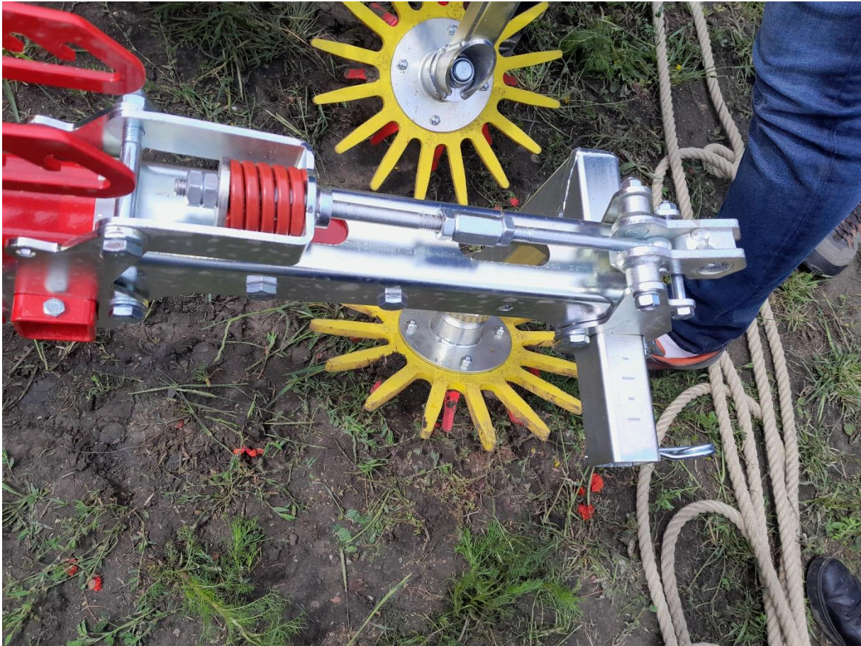
Klemmmechanismus zur Einstellung des Abstandes der Fingerhacke zu den Kulturpflanzen
