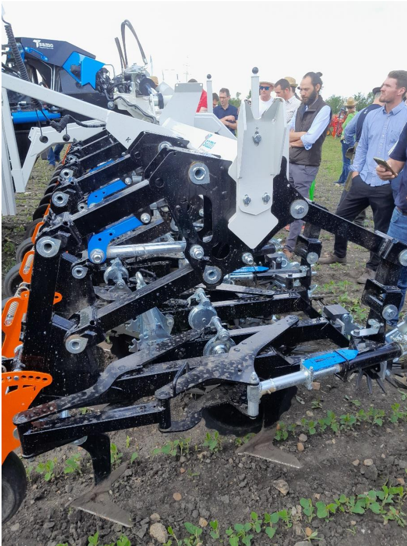
Verstellung der Hackbreite durch Spindel
