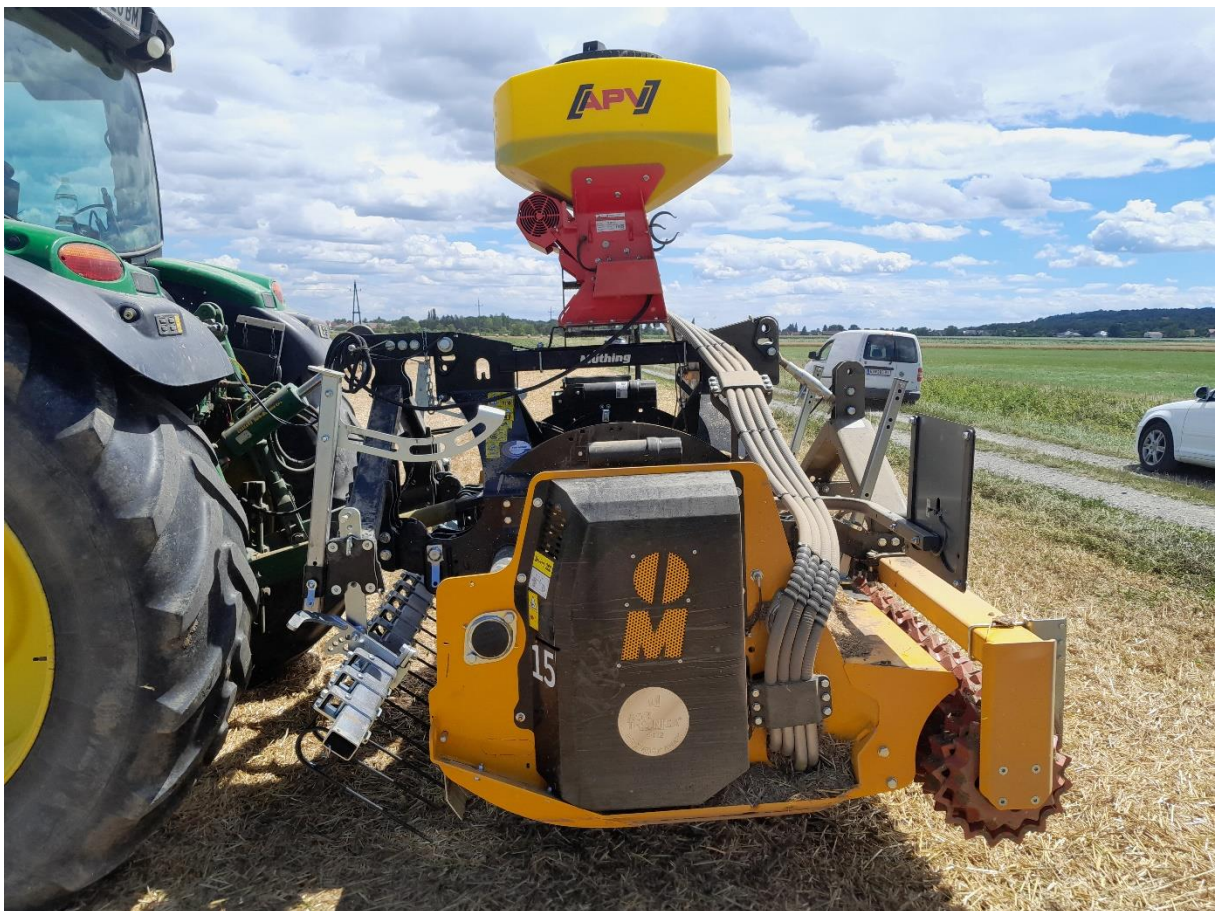
Abb.: von links nach rechts: Vorbaustriegel, Mulcher mit Aufbau-Sägerät, Saatgut-Zufuhrleitungen, Nachlauf-Prismenwalze
