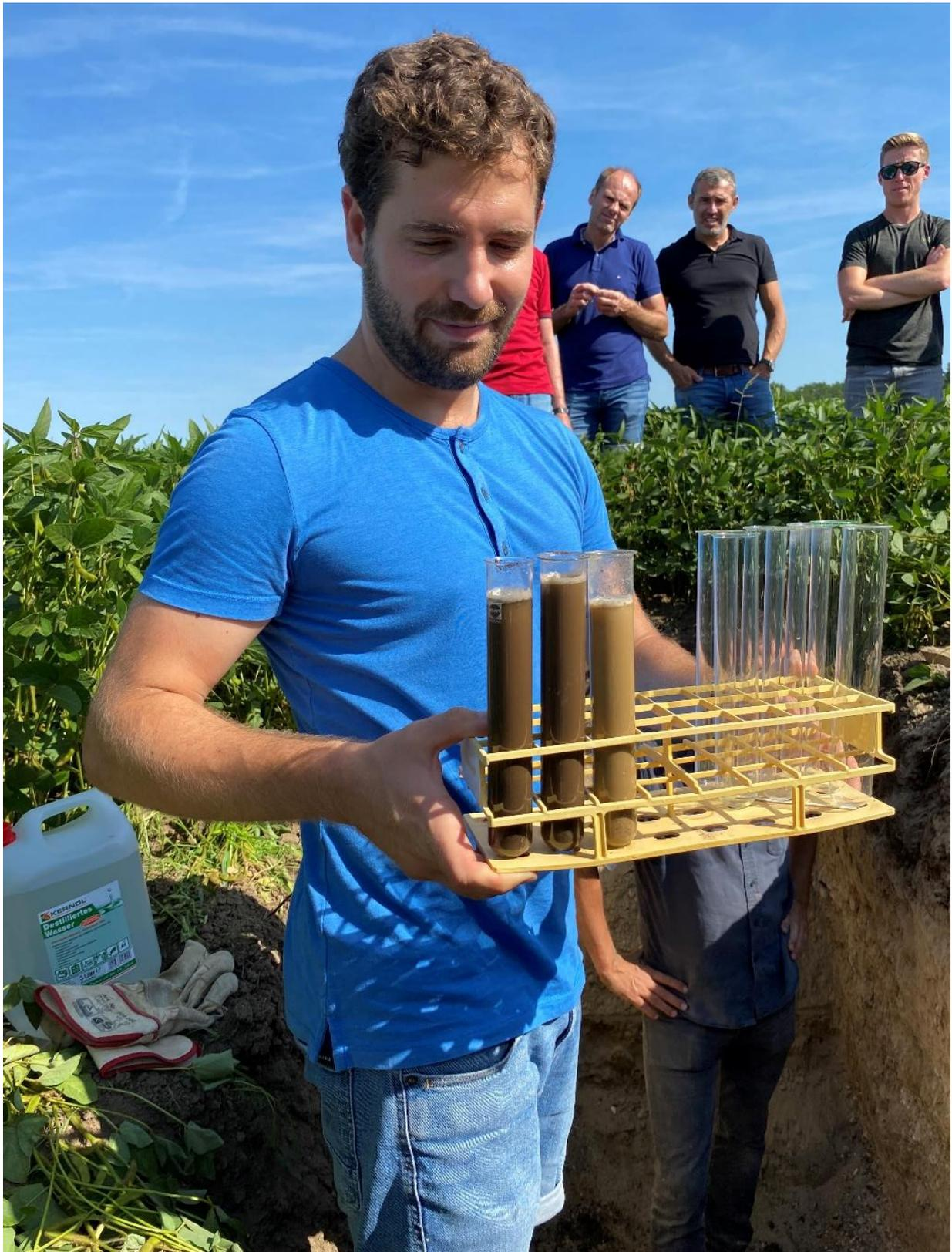
Foto 6: Schlämmtest des Bodens aus unterschiedlicher Bodentiefe © Winkovitsch
