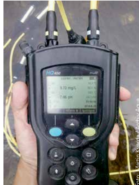
Messsonde zur Bestimmung des pH-Wertes.
