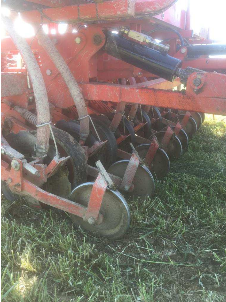
Einscheiben-No-Till-Sämaschine mit Andruckrolle bei der Saat von Sojabohne in eine abgeerntete Zwischenfrucht
