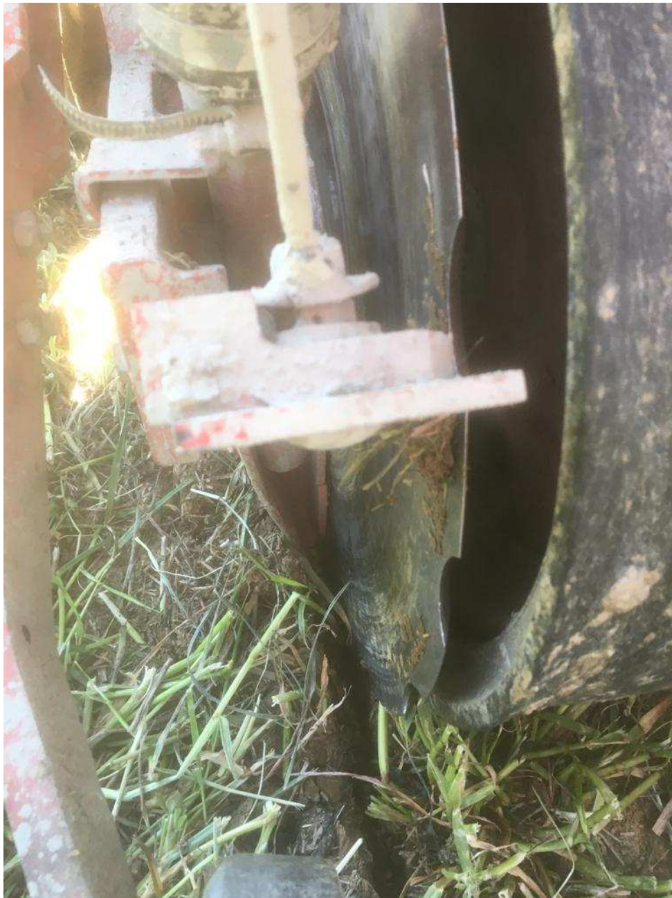
Sauberer Säschlitz durch Einscheibenschar, Saatgutablage durch Sästiefel
