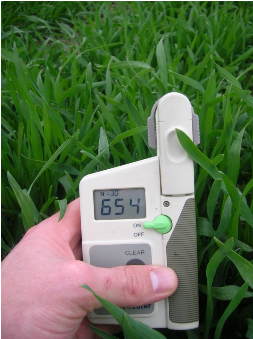
Abb. 1 Der N-Tester misst die Blattfarbe der Getreidepflanzen
