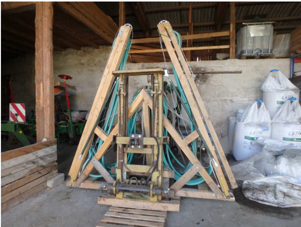
Abb.3: 15m-Eigenbau-Vordruschsaatgerät (in Kombination mit einem Frontsätank) der Familie Koch, Markt Allhau- Aussaat mittels pneumatischer Verteilung
