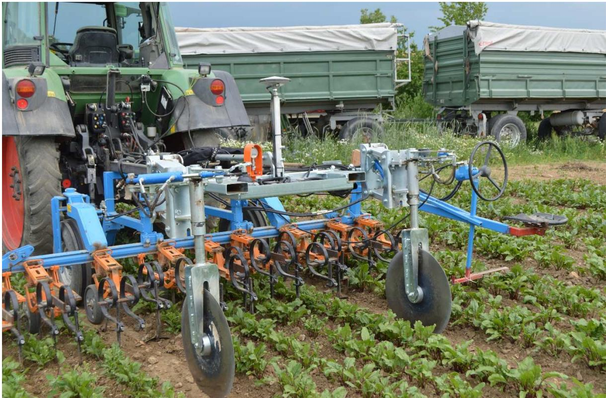
Abb.10: Hackgerät mit Koppelrahmen, Lenksechen und RTK-System
