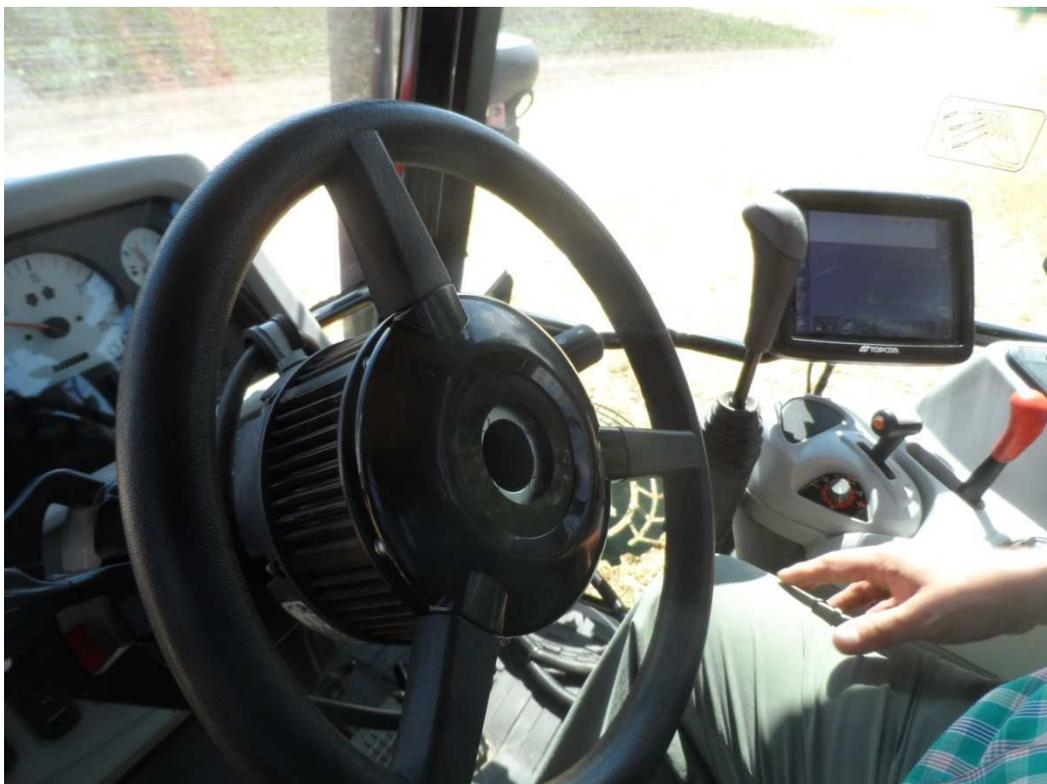
Abb.1: RTK System mit Lenkautomat
