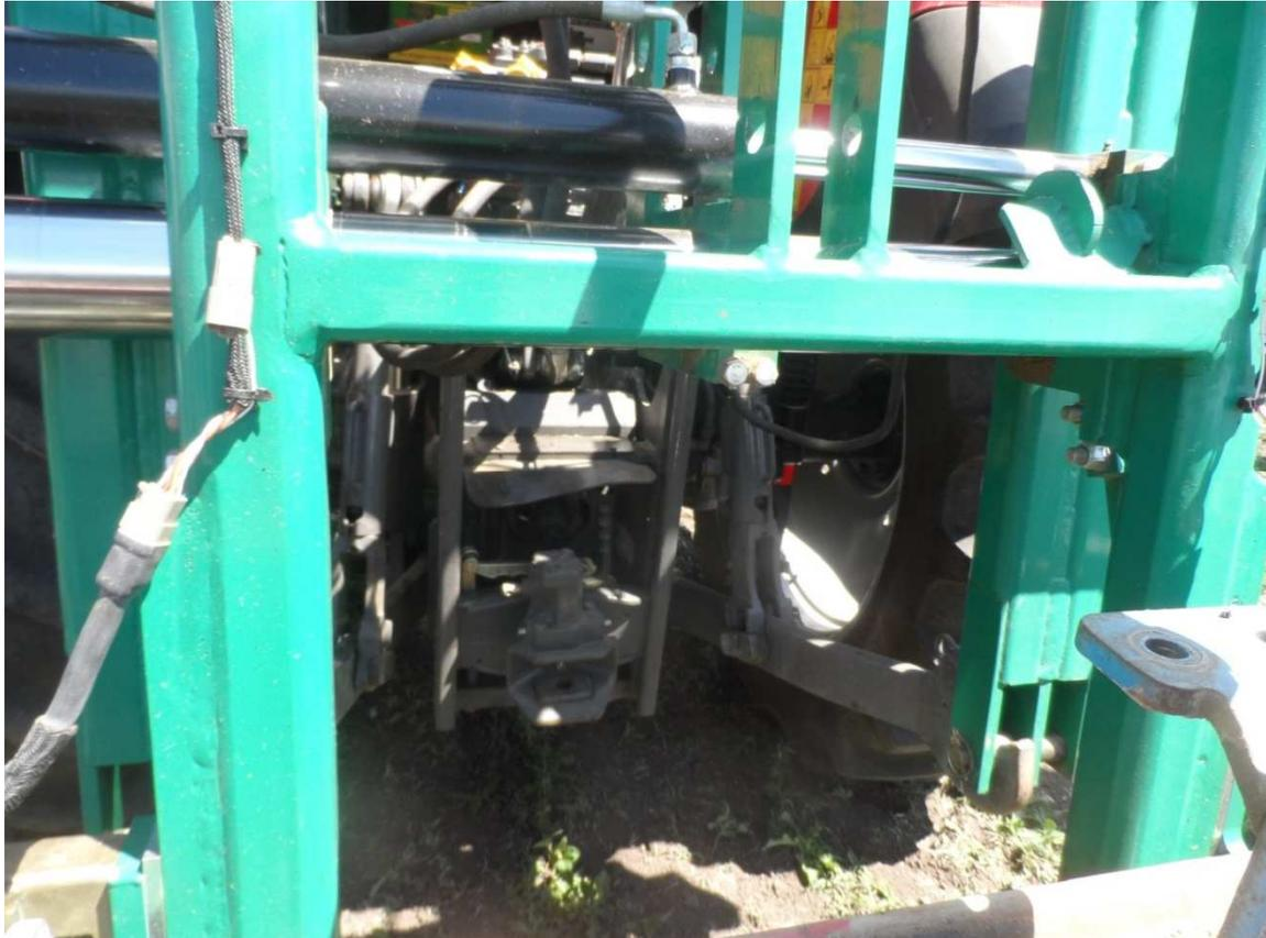
Abb.9: Für den Einsatz eines Verschieberahmens z.B. beim Fräsen von Dämmen: Zapfwellendurchgang beachten!
