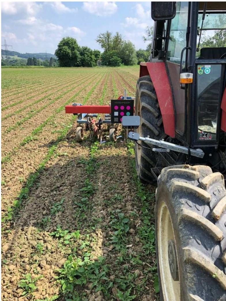
Abb.12: Traktor mit Kamera, Hackgerät mit Referenztafel
