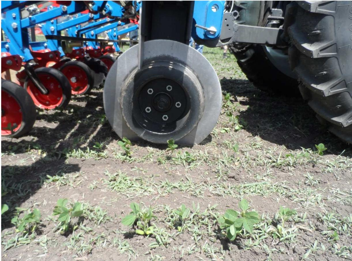
Abb.6: Spurführungsräder des Verschieberahmens
