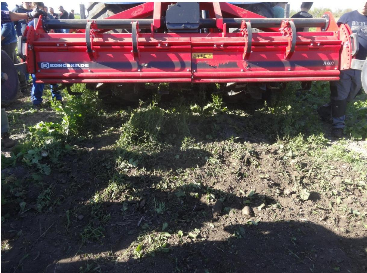
Abb.24: Arbeitsbild Bodenfräse Kongskilde (Howard) R600S mit geschlossener Heckklappe
