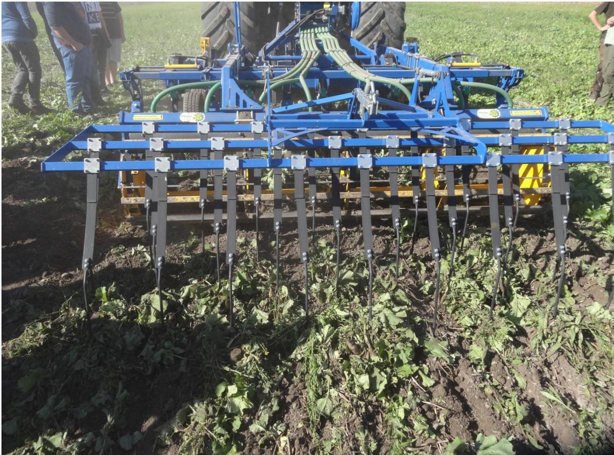
Abb.13: Arbeitsbild Grubber Treffler TGA
