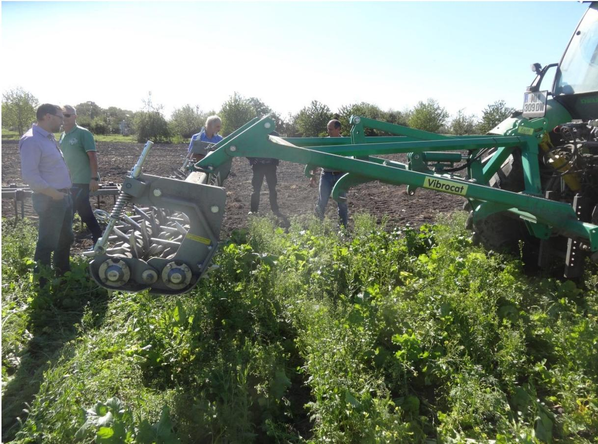
Abb.10: Einsatz der Sterncracker-Walze nach Demontage des Arbeitsfeldes zum Niederdrücken des ZWF-Bestandes
