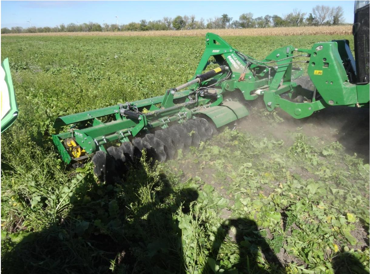
Abb.7: Arbeitsbild Messerwalzen-Wellscheiben-Kombination: Kerner X-Cut Solo 600
