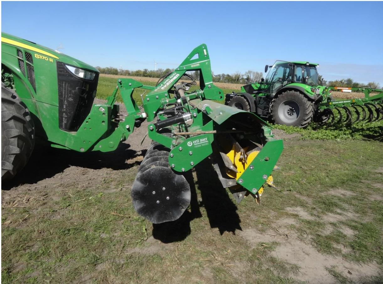
Abb.6: Messerscheiben-Wellscheiben-Kombination: Kerner X-Cut Solo 600
