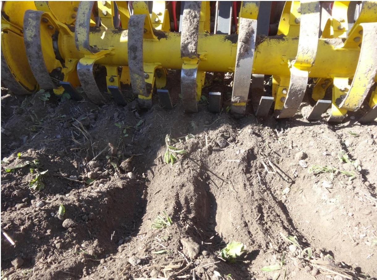
Abb.16: Wellenförmiges Bearbeitungsprofil unmittelbar hinter der Walze
