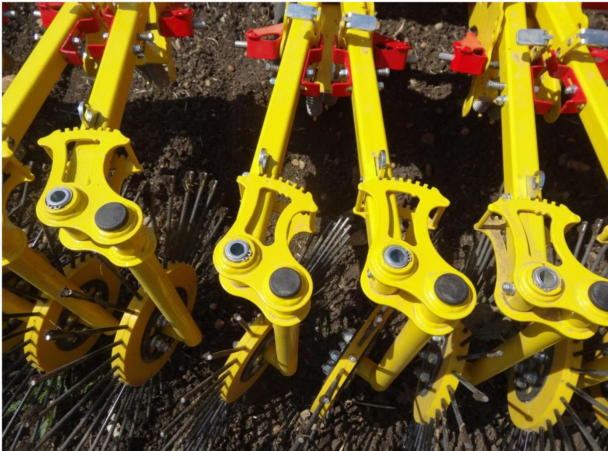
Abb.2: verstellbarer Anstellwinkel der einzelnen Hackringe –
