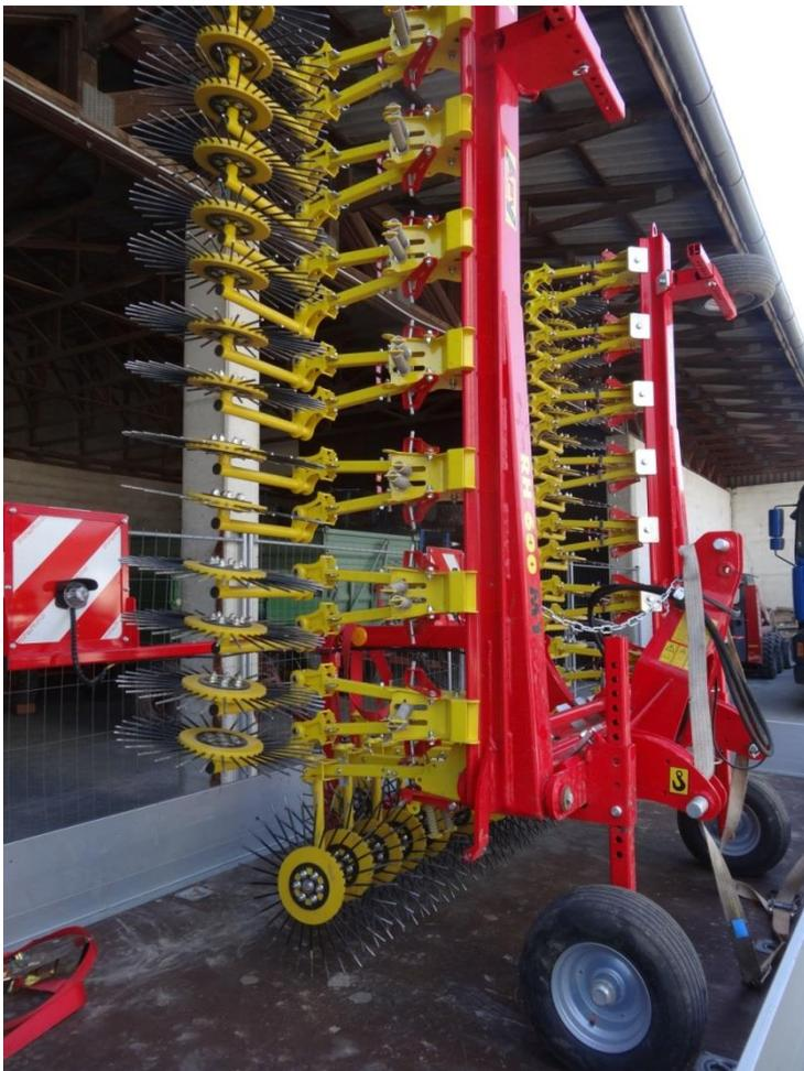
Abb.1: Rollhacke mit schräg angestellten Hackringen
