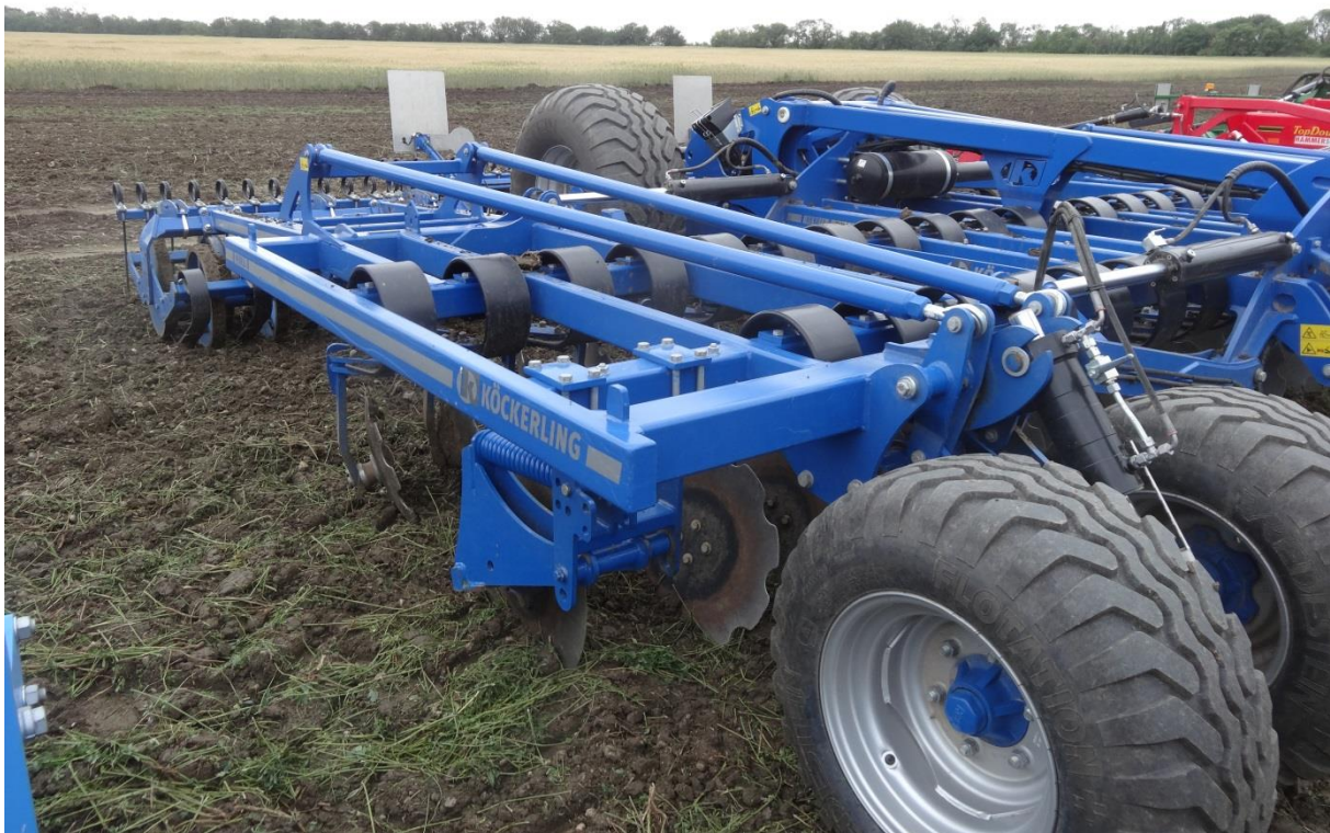
Abb.5: Köckerling Rebell 6m mit Anbaulaschen, Fronträdern und Nachlaufstriegel
