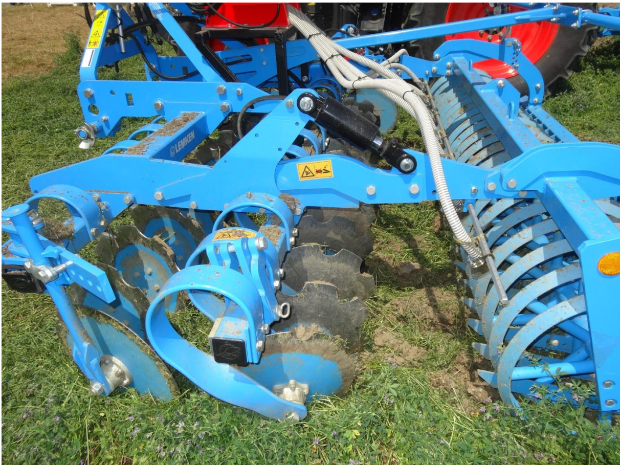
Abb.10: Schnittwinkel der Scheiben 10,5° zur Bodenoberfläche Ablage des Saatgutes vor dem Nachläufer
