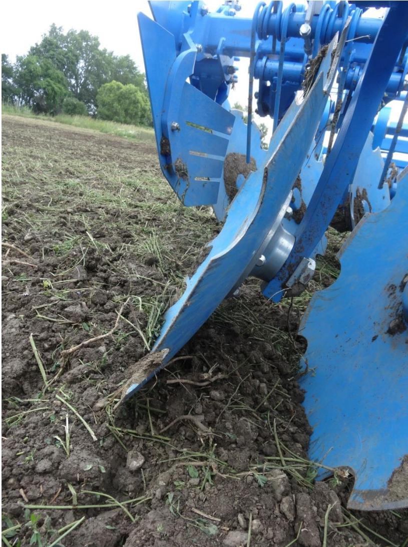
Abb.2: Scheibenanstellung: 20° Schnittwinkel zum Boden
