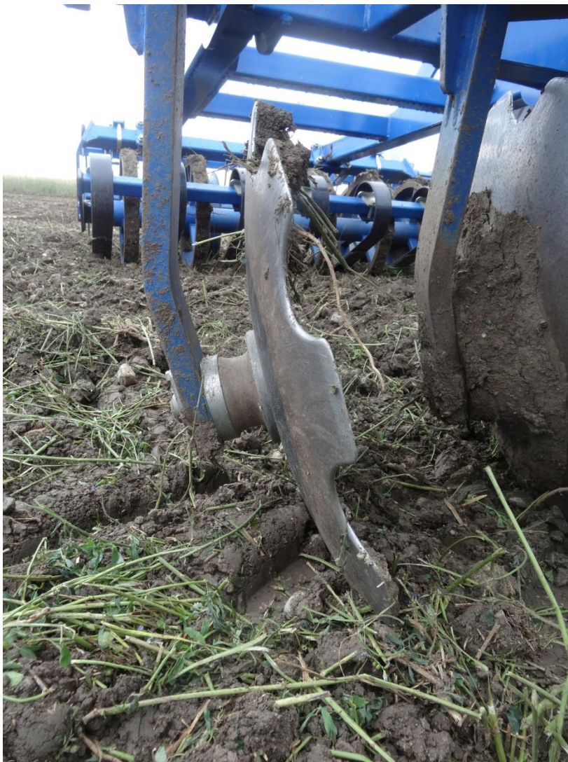
Abb.7: Scheibenanstellung 16° Schnittwinkel zum Boden
