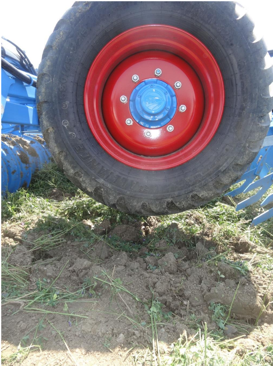
Abb.3: Aushebung der Transporträder, volle Abstützung auf Zugdeichsel und Nachläufer
