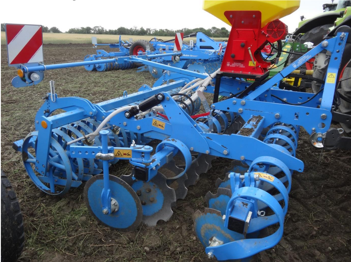
Abb.9: Lemken Heliodor 9/300 mit Aufbau-Sämaschine APV PS 200 M1
