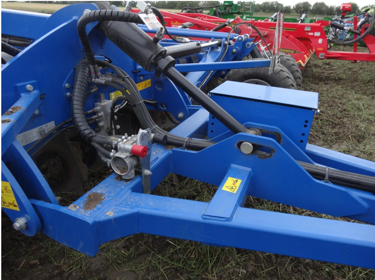
Abb.6: Fronträder (im Hintergrund) und Langloch in der Zugdeichsel-Abstützung
