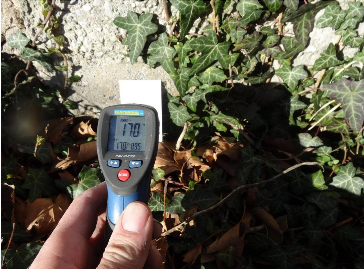
Abb.3: Messung der Umgebungstemperatur (auf der Oberfläche eines weißen Blattes) z.B. 17,0°C am 13.3. 2018
