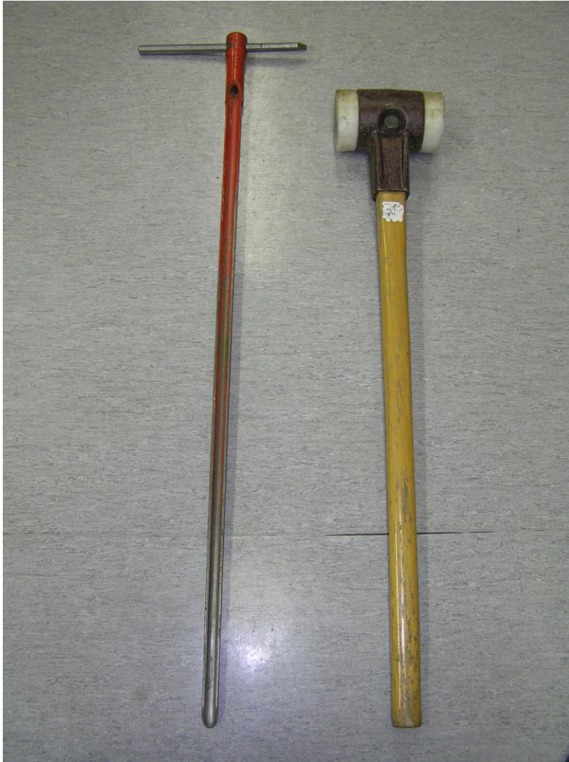
Abb. 3: Bodenbohrer zur Probenahme bis maximal 90 cm Bodentiefe
