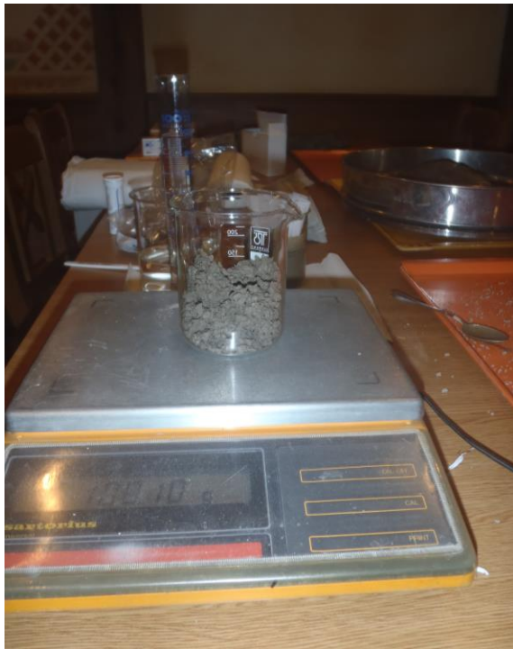
Abb.5 Abwiegen von 100 g Boden in einem Gefäß. Im Hintergrund ein Sieb zum Absieben von Grobanteilen (Steine)
