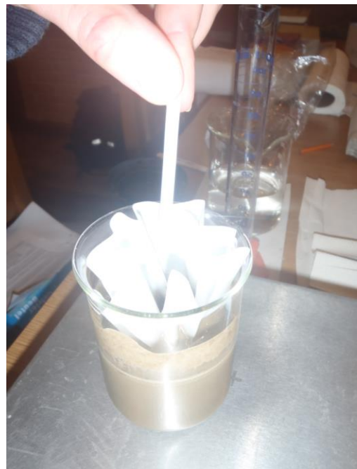
Abb.8 Eintauchen des Teststreifens in die klare Flüssigkeit für 1 Sekunde, Teststreifen abschütteln und 1 Minute warten
