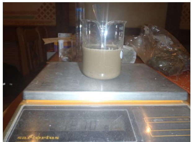
Abb. 6: Umrühren von 100 g Boden und 100 ml Wasser, bis der Boden vollständig aufgeschlämmt ist.
