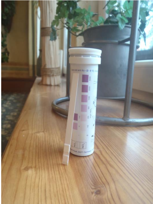
Abb. 9: Messstreifen und Skala Das außenliegende (im obigen Bild das untere) Messfeld verfärbt sich umso dunkler, je höher der Nitrat ( \text{NO}_3^- )-Gehalt ist.
