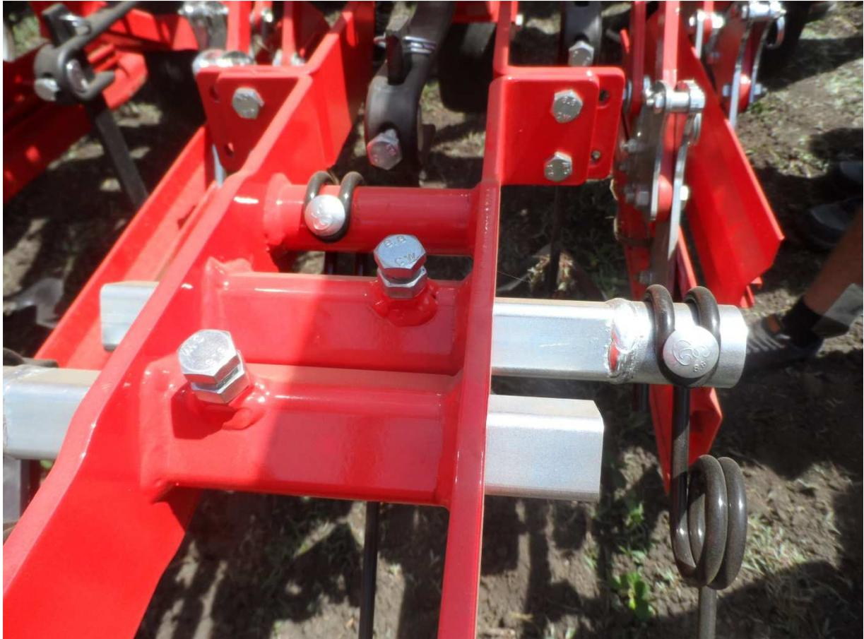
Abb.18: Einstellmöglichkeit der äußeren Zinken
