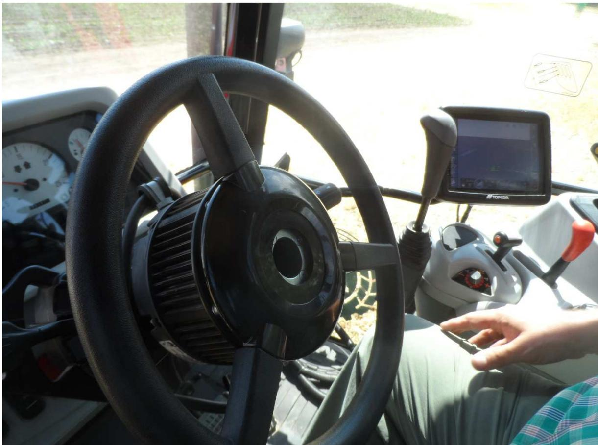
Abb.1: RTK System mit Lenkautomat zur exakten Anlage der Versuchspartellen
