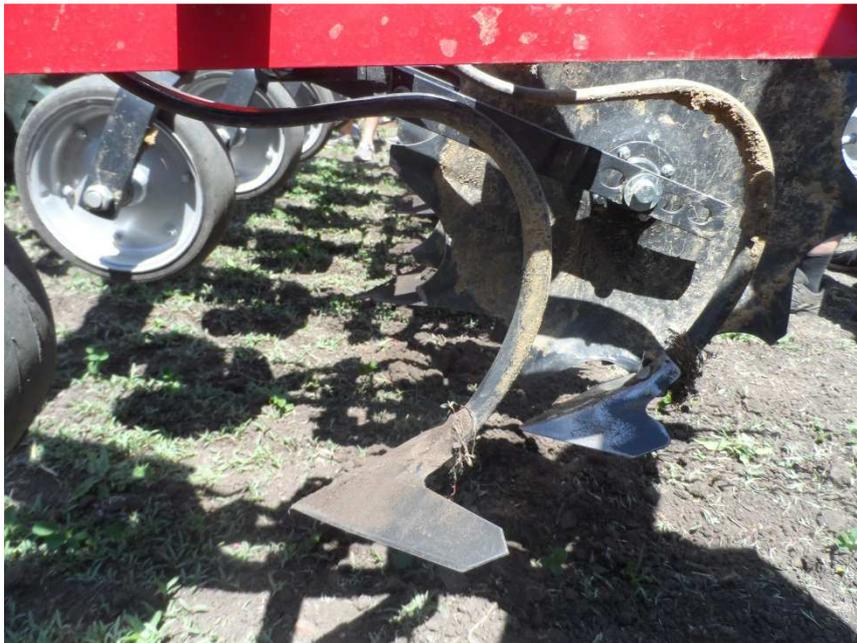
Abb.10: S-Zinken mit variablem Einzugswinkel der Schare
