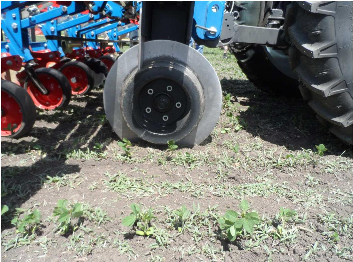
Abb.6: Spurführungsräder des Verschieberahmens
