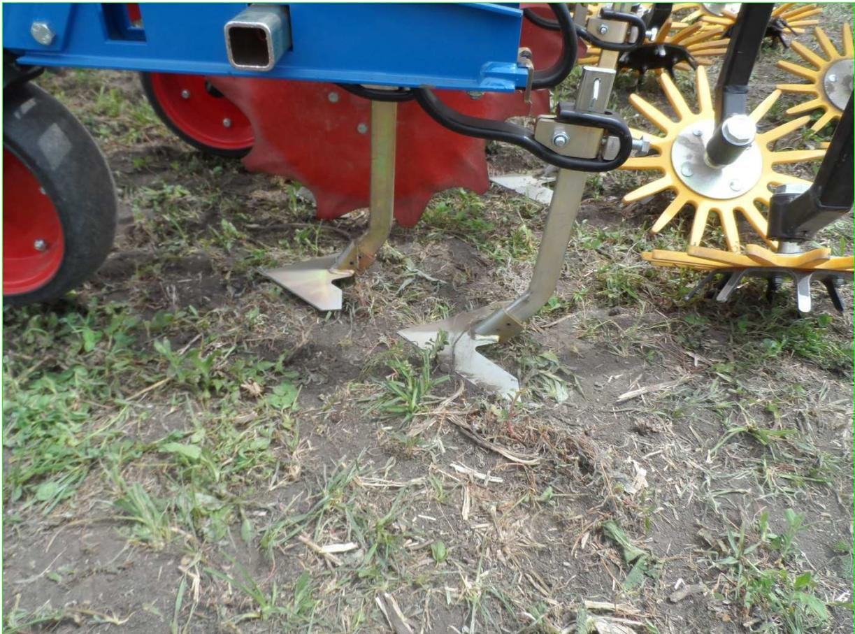
Abb.11: Vibrozinken mit stabilem Einzugswinkel der Schare
