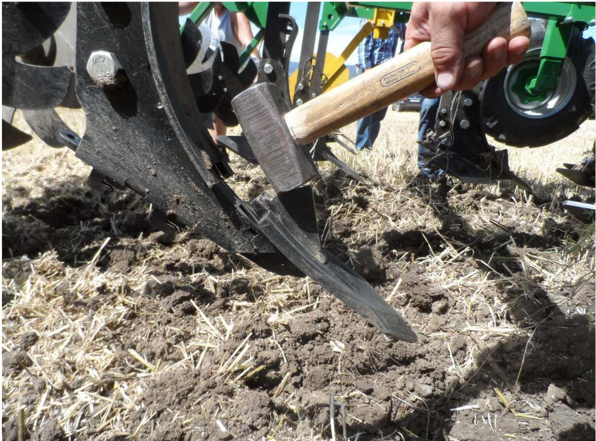
Abb.4: Wechsel der Scharspitzen und Leitbleche auf z.B. Schmalschare auch am Feld möglich
