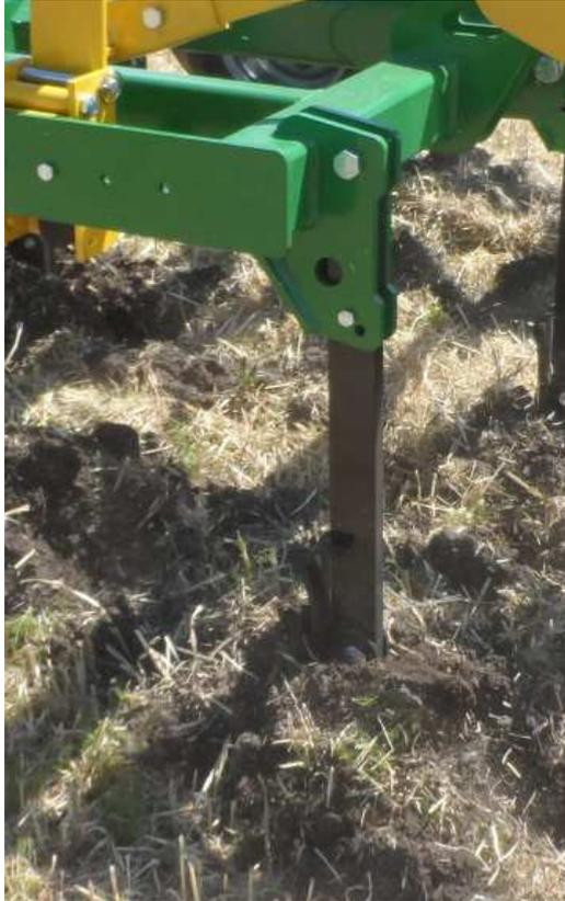
Abb.8: Mehrere Löcher für den Scherbolzen in der Zinkenhalterung ermöglichen eine unterschiedliche Einstellung der Zinken­neigung
