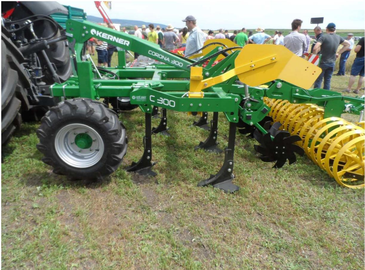
Abb.1: Schwergrubber mit Front-Stützrädern, Schar- Schnellwechselsystem, Sternscheiben und Packerwalze
