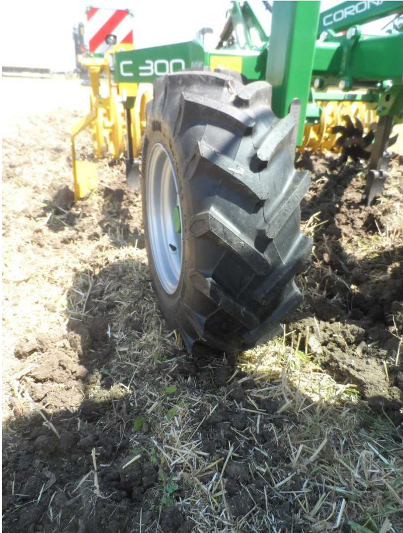
Abb.6: Stützräder sollen auf festem Boden fahren
