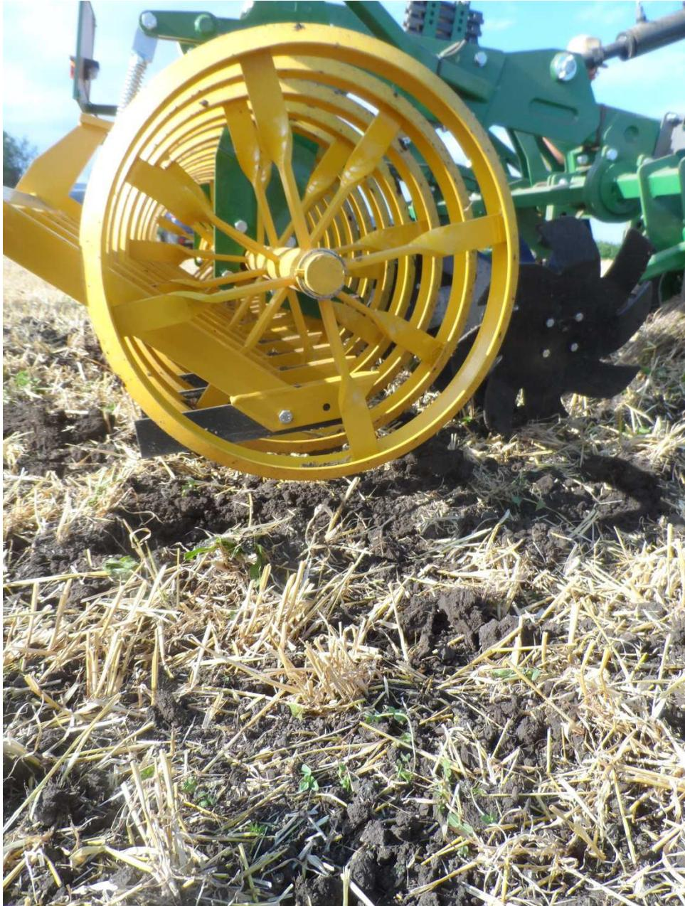
Abb.5: Grubbern mit aufgehobener Packerwalze
