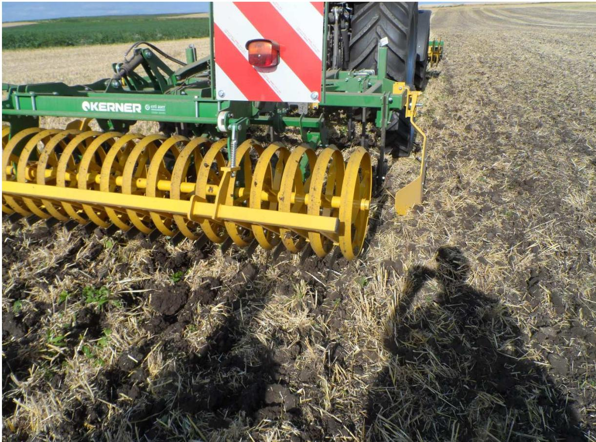
Abb.10: Links: Arbeitsbild des Schwergrubbers ohne Eingriff der Packerwalze
