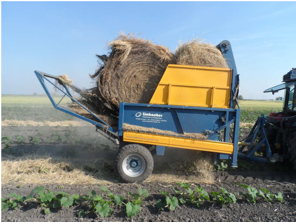
Abb.1: Gerät zum Auflösen, Häckseln und Einstreuen von Rundballen
