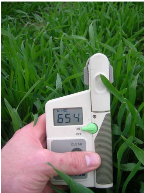
Abb. 2 Der N-Tester misst die Blattfarbe der Getreidepflanzen
