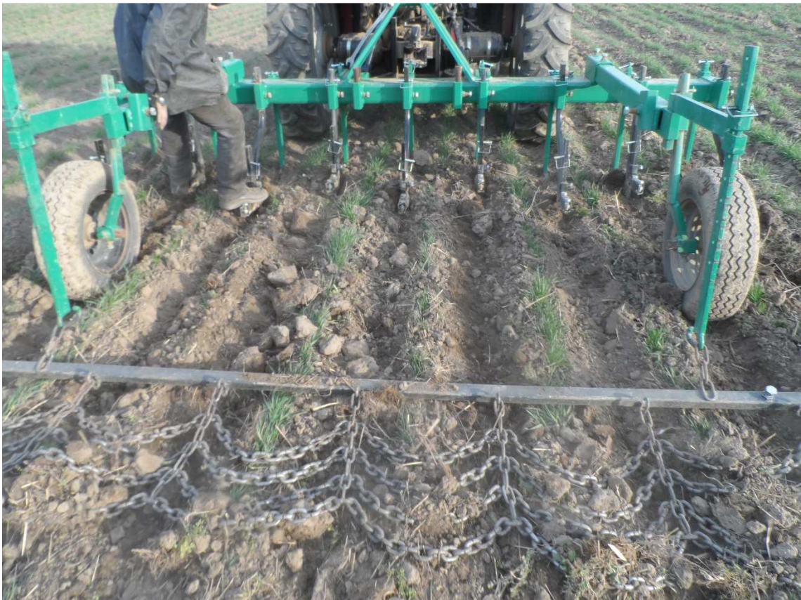
Abb.4: Hacken von Wintergetreide in Dammkultur: Selbstführung durch Zinken in Führungsrillen, nachlaufende Kettenschleppe
