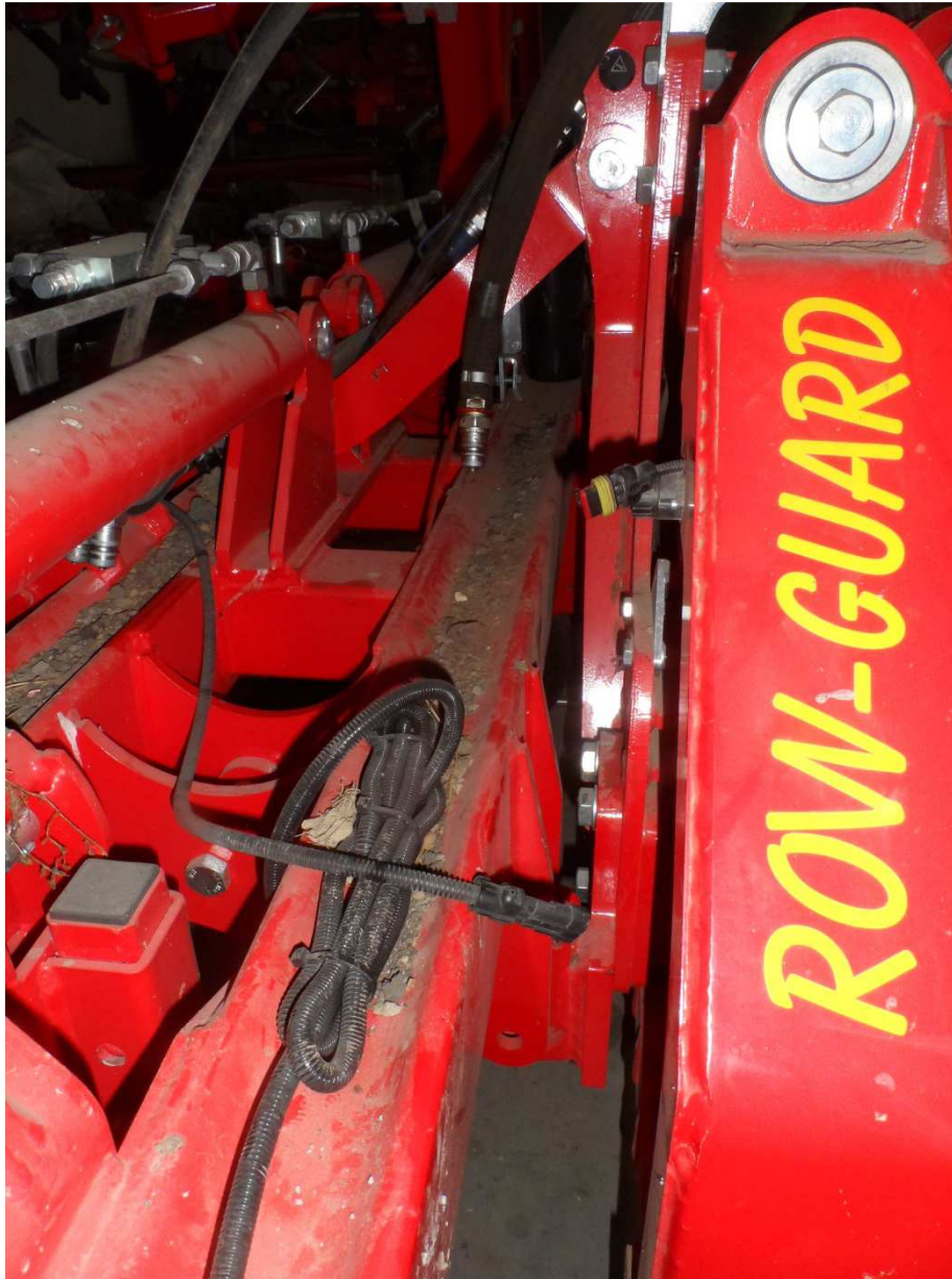
Abb.2 Verbindung zwischen Verschieberahmen und Hackgerät mittels Schnellkuppler und Bolzen
