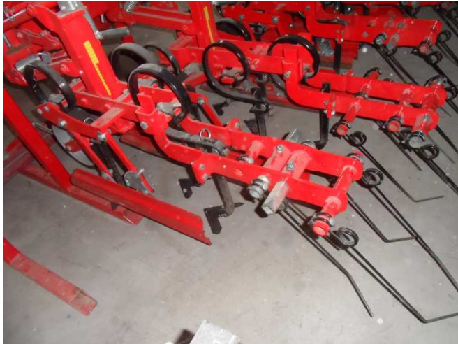
Abb.54: 45cm-Hackgerät mit Vibro-Zinken und Nachlaufstriegel
