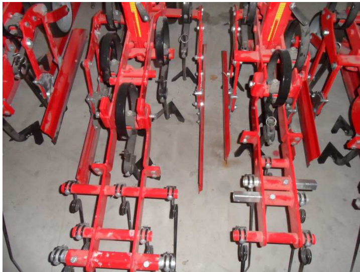
Abb.7: Links: Fahrgasse (Reihenweite 70cm) in der Reifenspur Rechts: Reihenweite 45 cm außerhalb der Reifenspur
