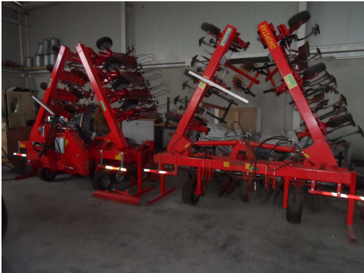
Abb.1: Links: Hackgerät für Kulturen mit 45cm-Reihenabstand, mit Verschieberahmen Rechts: Hackgerät für Kulturen mit 75 cm Reihenabstand, ohne Verschieberahmen
