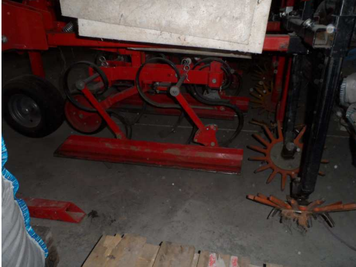
Abb.3: 75cm-Hackgerät mit S-Zinken und Fingerhacke
