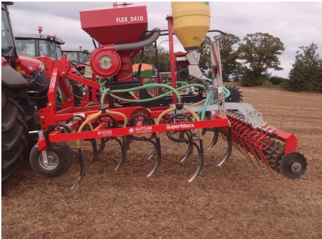
Abb.4: Leichtgrubber mit Stützrädern vorne zur Einhaltung einer gleichmäßig flachen Arbeitstiefe - ohne auf die Tiefenführung durch den Nachläufer angewiesen zu sein.
