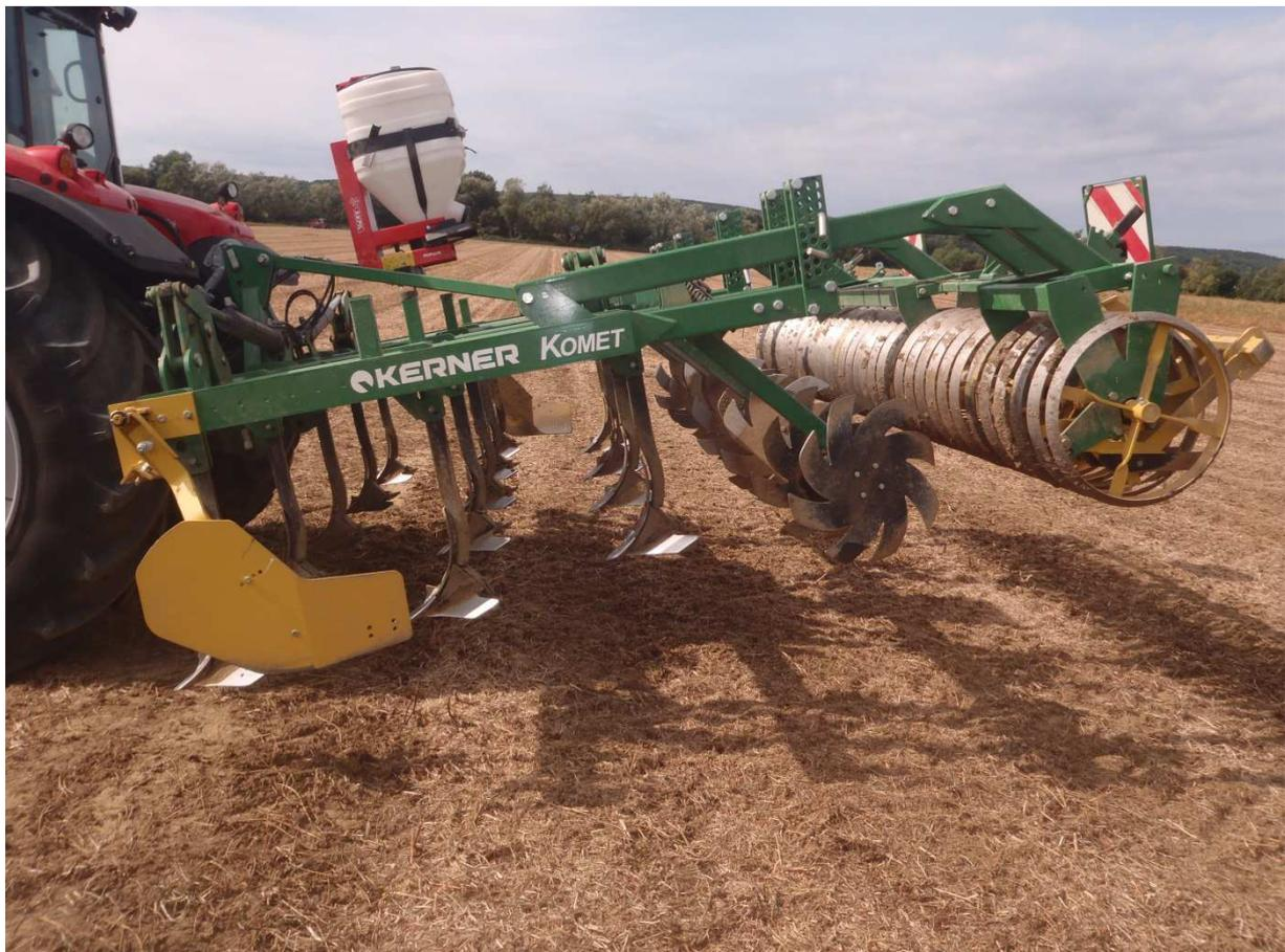
Abb.3: Grubber mit schnell demontierbaren Flügelscharen und Transportflaschen am Rahmen.
