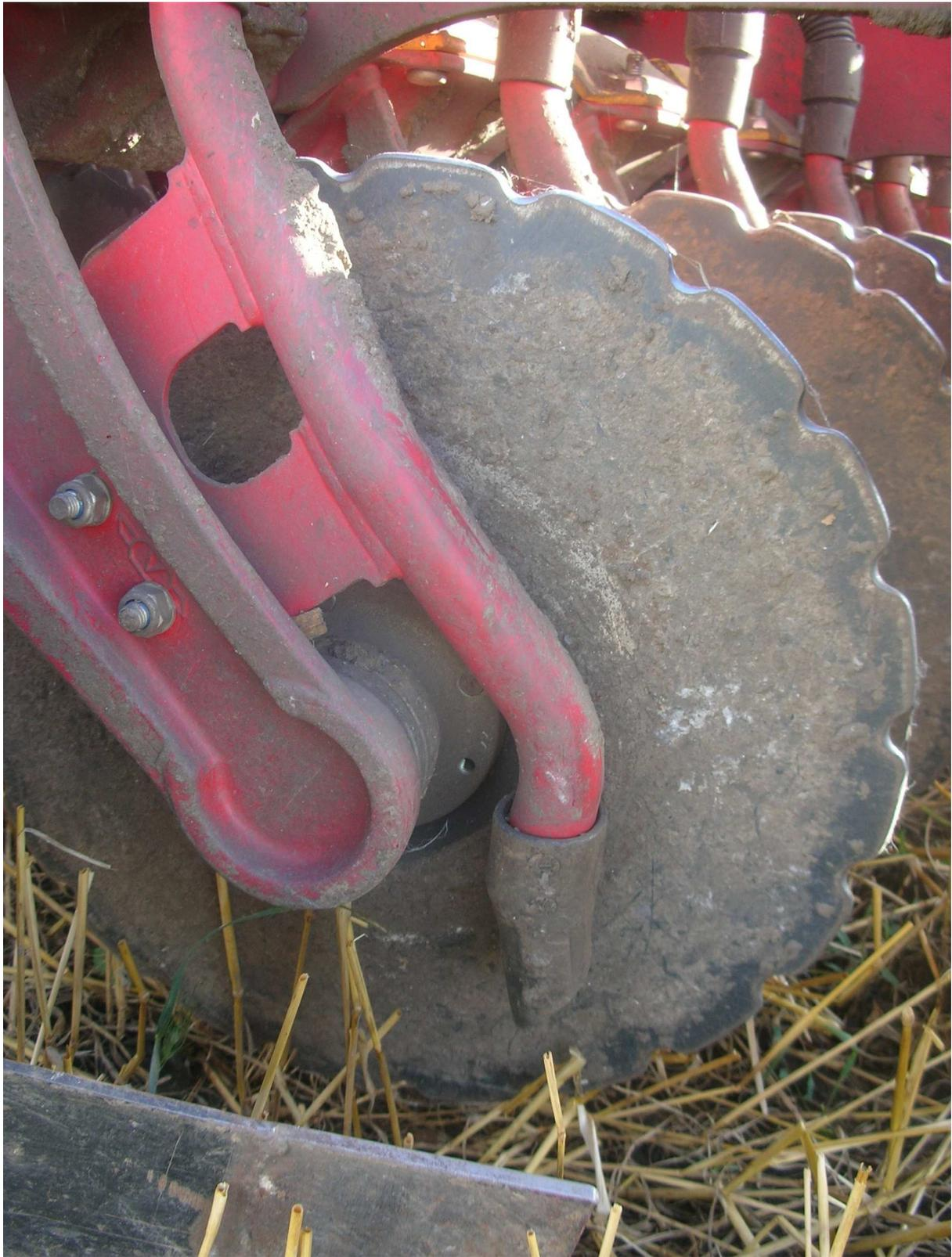
Abb. 2 Säeinheit einer Mulchsaatmaschine: Das Saatgut wird im Schatten einer Kurzscheibenegge abgelegt
