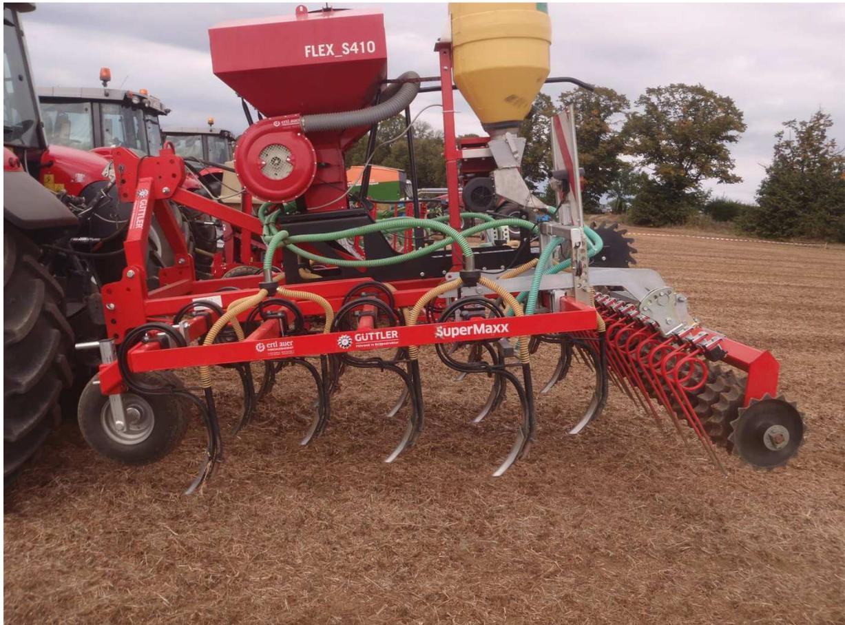
Abb.4: Tiefenführung durch Fronträder, hochstellbare Nachlaufwalze
