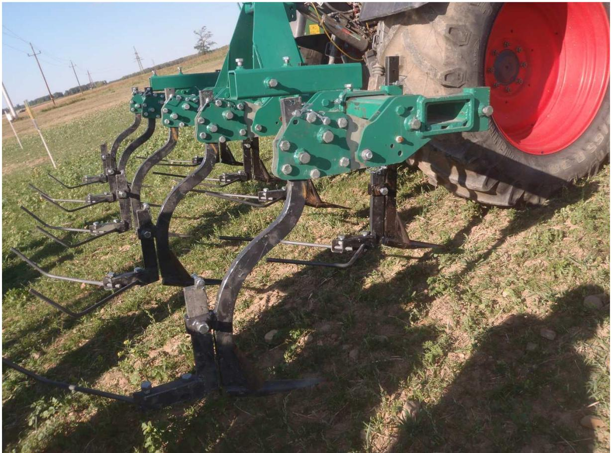
Abb.5: Häufelpflug mit schmalen, abgerundeten Spitzen und flachen, quergestellten Stäben, ohne Nachläufer (nicht im Bild: Tiefenführung durch Traktorhydraulik und Tasträder)
