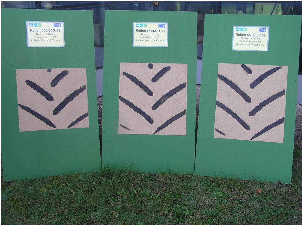
Abb.1: Vergrößerung der Reifenaufstandsfläche durch verringerten Reifeninnendruck Reifeninnendruck von links nach rechts: 1,6 bar – 1,0 bar – 0,8 bar
