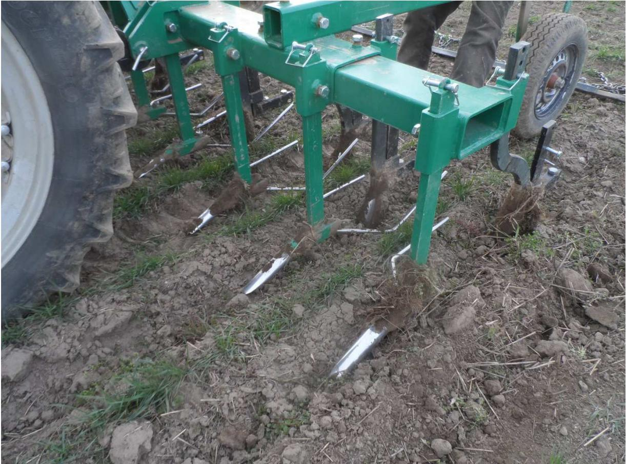
Abb.10: Hacken von Wintergetreide im Frühjahr (im Bild: Gerät noch nicht in den Boden eingezogen); Aufnahme vom 7.4.2015
