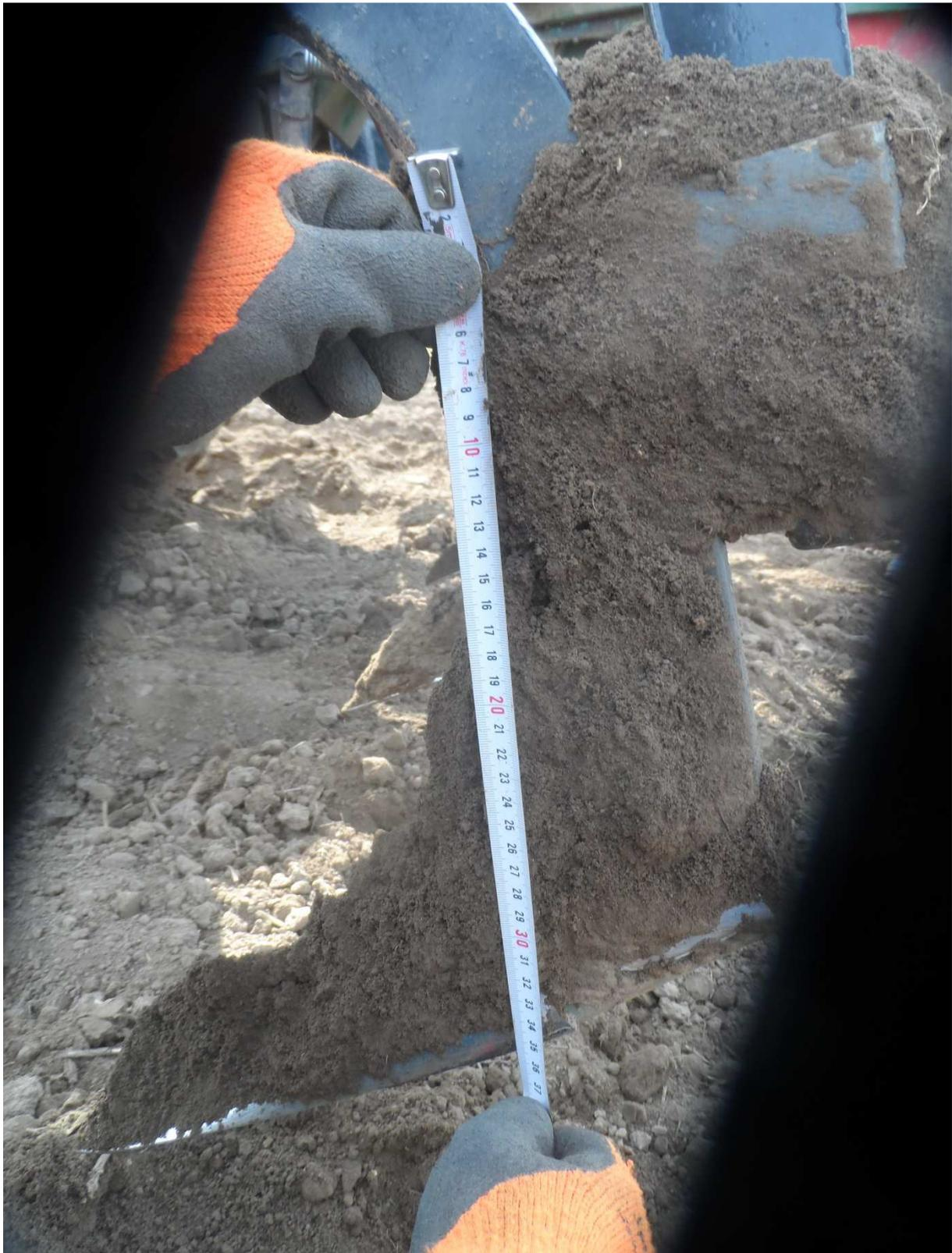
Abb.6: 37 cm Arbeitstiefe zur Durchbrechung der Pflugsohle bei ausreichend trockenen Bedingungen in dieser Bodentiefe; Aufnahmedatum: 7.4.2014
