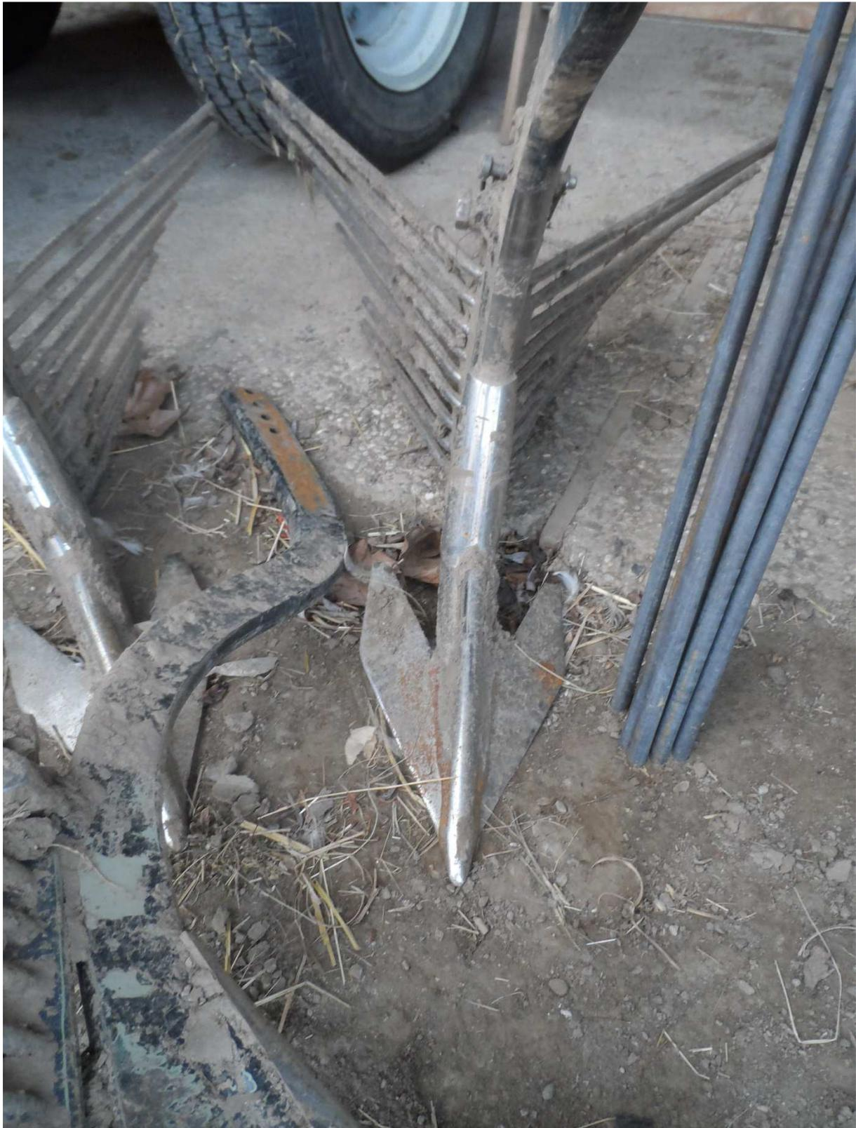
Abb.4: Zinken für die Dammformung
