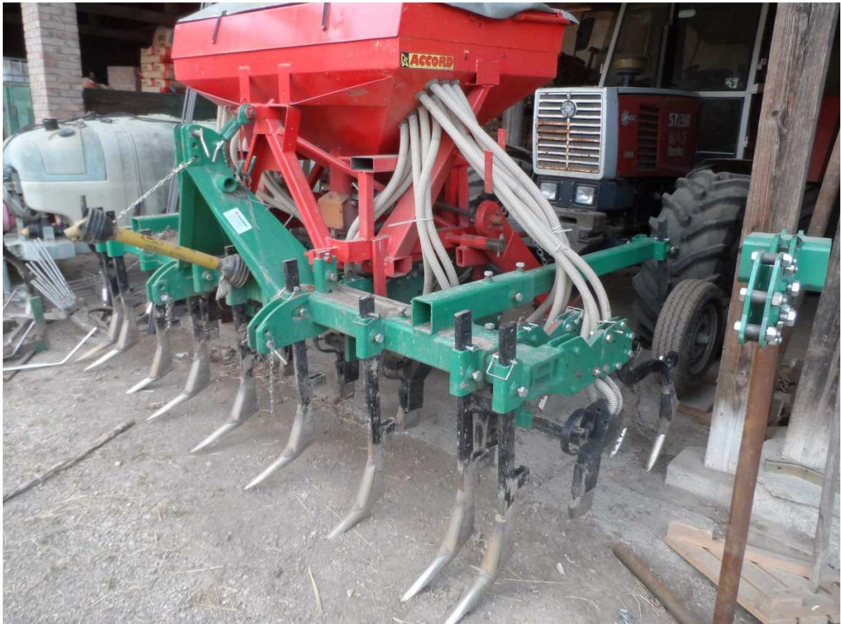
Abb.2: Zinkenträger mit zwei Zinkenreihen, dazwischen Bandsaat von Getreide mittels Aufbau-Sämaschine (Randreihen für den Straßentransport zusammengeschoben, im Feld teleskopierbar)
