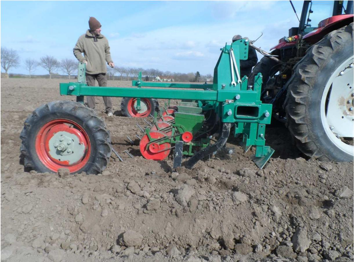
Abb.8: Gleichzeitige tiefe Lockerung der Dammschle und Einzelkornsaat auf der Dammkrone, Aufnahme vom 7.4. 2015
