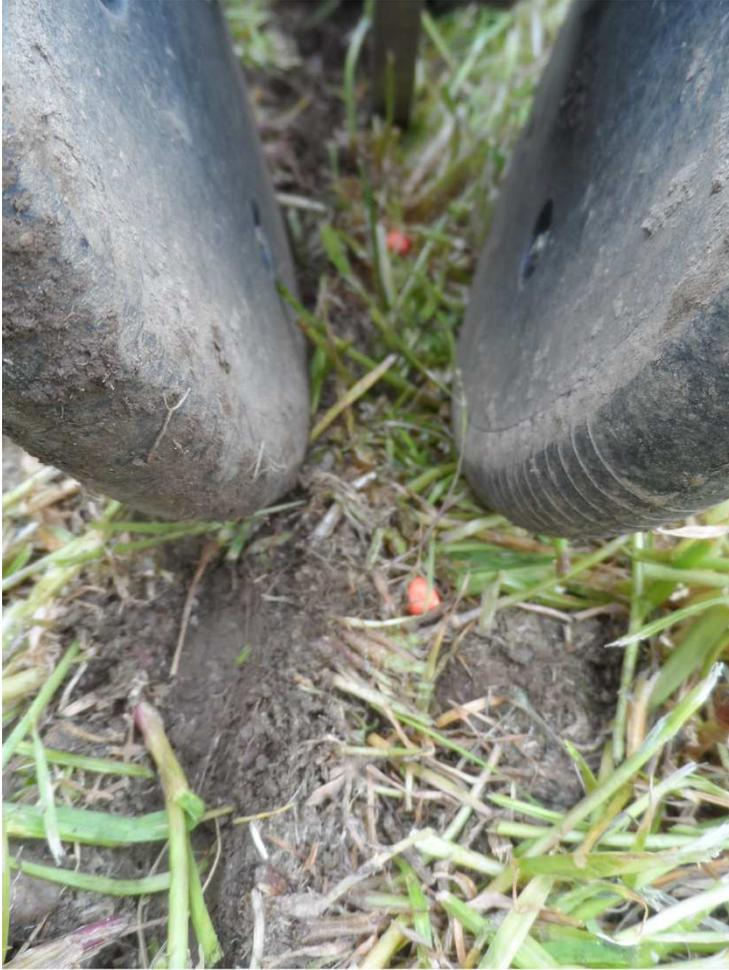
Abb.12: Reihengrubber als Vorwerkzeug: keine Einbettung des Saatkorns bei nicht exakter Einstellung
