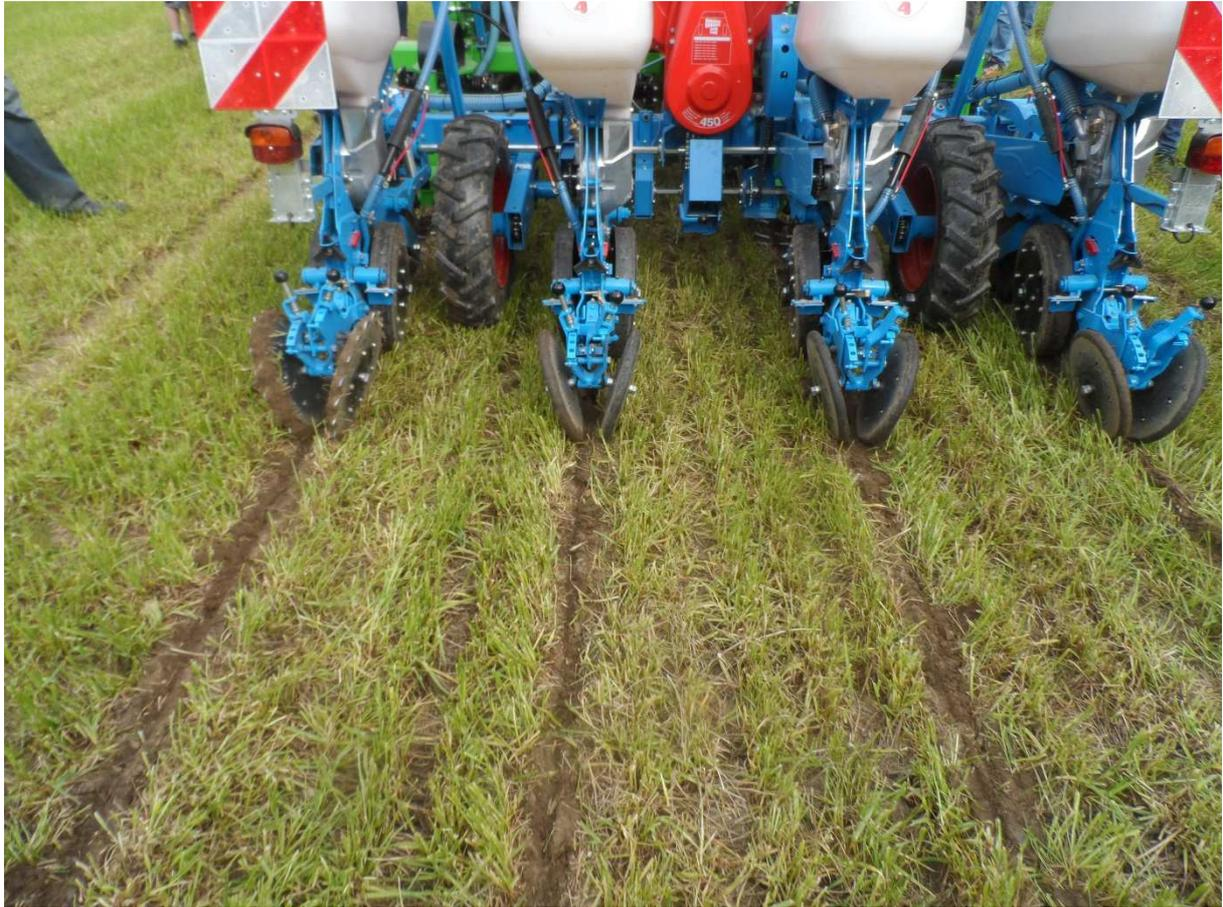
Abb.9: Reihengrubber (Strip Till) als Vorwerkzeug bei der Saat in Weidelgras-Zwischenfrucht - schmaler Bereich offenen Bodens
