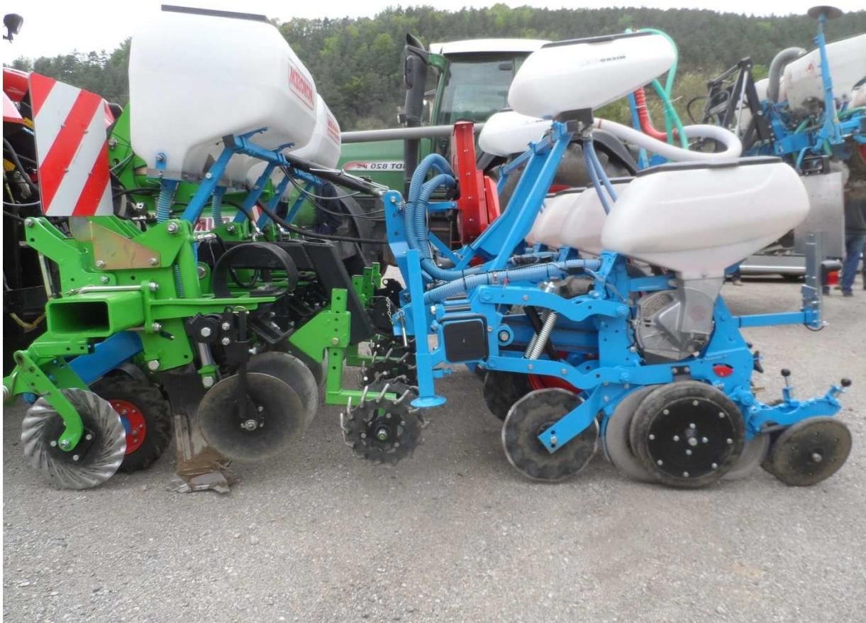
Abb.6: Kombination aus Reihengrubber (Strip Till) und Einzelkorn-Sägerät:
