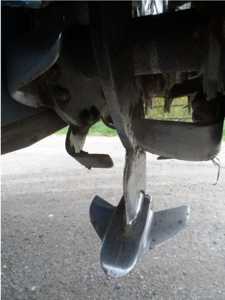
Abb.15: Lockerungszinken zwischen zwei Winkelmessern, Erdauswurf durch Randbleche begrenzt
