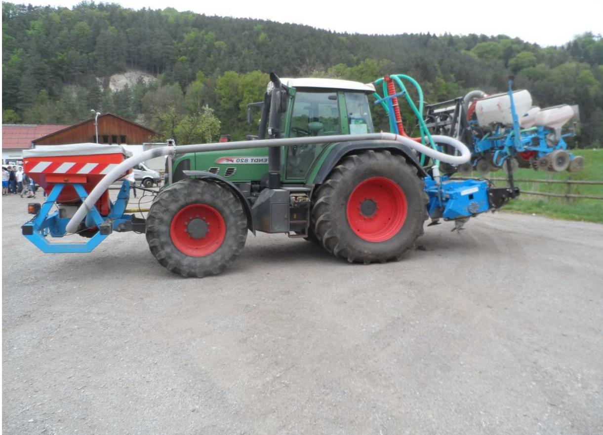
Abb.14: Front-Düngetank, Reihenfräse, Einzelkorn-Sämaschine
