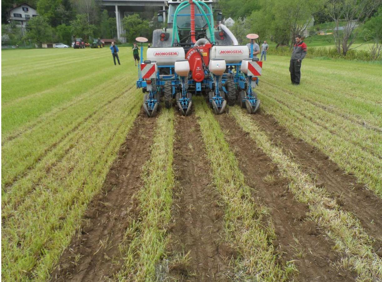
Abb.17: Reihenfräse als Vorwerkzeug bei Mais-Saat nach Weidelgras-Zwischenfrucht – problemlose Saat, aber relativ breiter Bereich offenen Bodens
