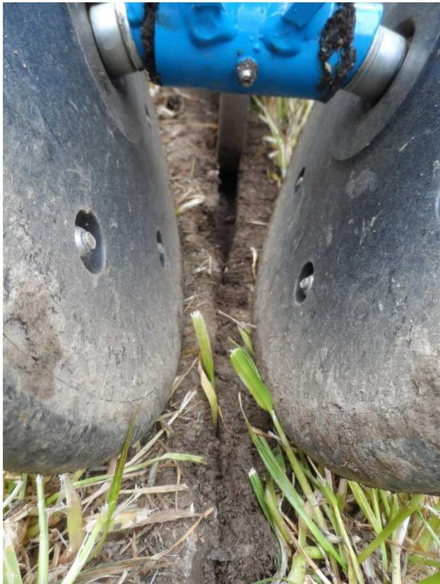
Abb.10: Reihengrubber als Vorwerkzeug: gute Saatgut-Einbettung bei exakter Einstellung
