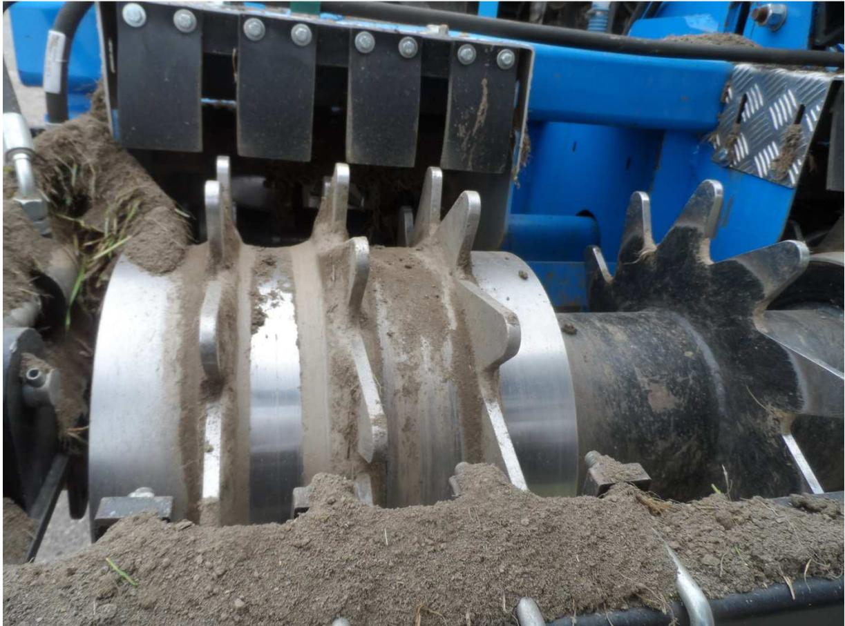
Abb.16: Zahnpacker-Walzensegmente für eine streifenweise Rückverfestigung, Zahnkranz als Zwangsantrieb
