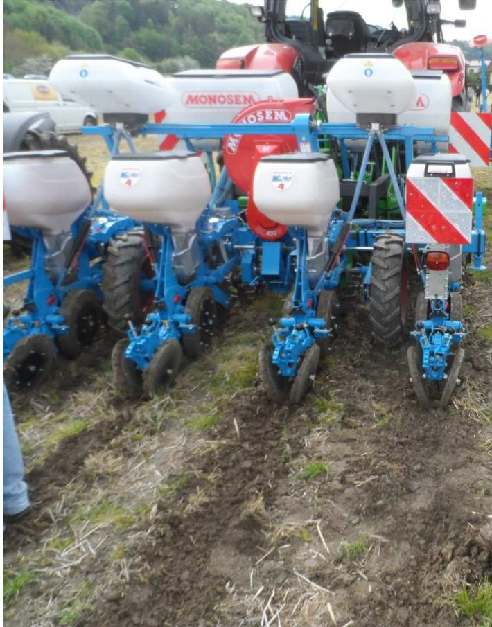
Abb.7: Reihengrubber (Strip Till) und Einzelkorn Saat auf abgefrostenem Zwischenfruchtbestand – gute Saatgutablage, breiteres Saatband ohne Mulchschicht
