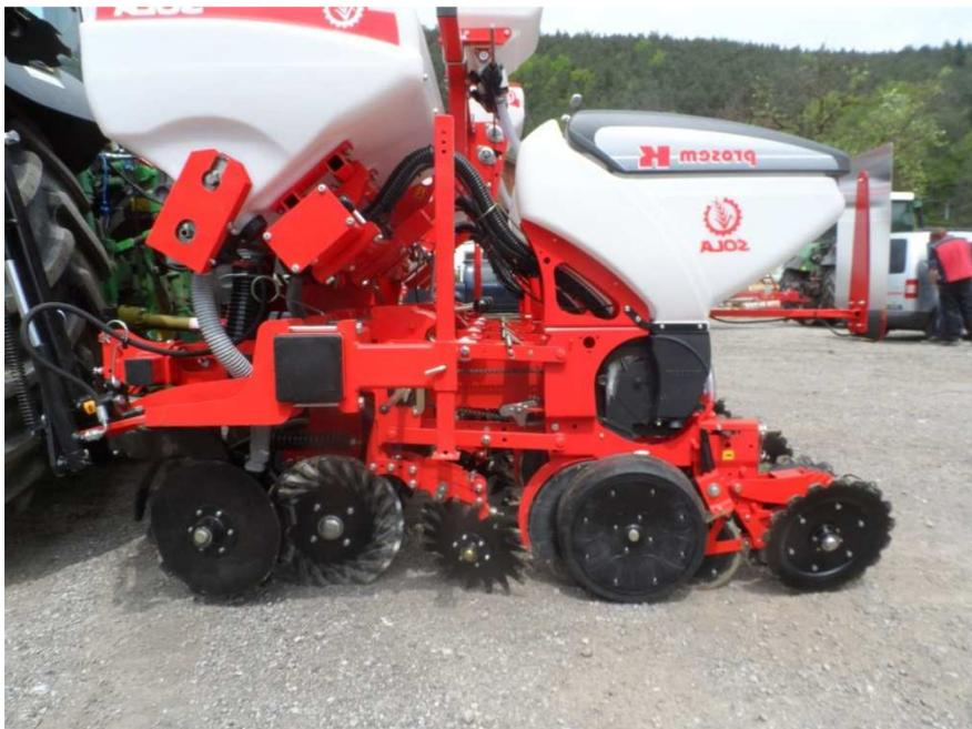
Abb.1: Einzelkornsägerät ohne besondere Vorwerkzeuge: von links nach rechts:
