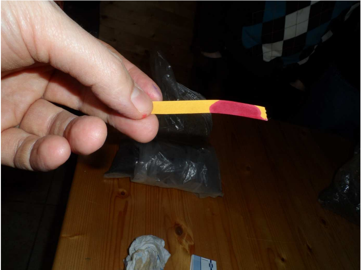
Abb.3: Vergleich des Indikatorpapiers mit der Farbskala (im Bild: Zur Darstellung eines starken Farbumschlages wurde Säure verwendet)
