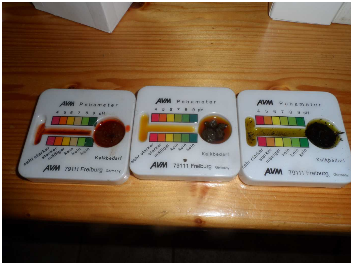
Abb.6: Vergleich der Indikatorlösung mit der Farbskala Im Bild: zunehmende pH(Neutralsalz) Werte von links nach rechts
