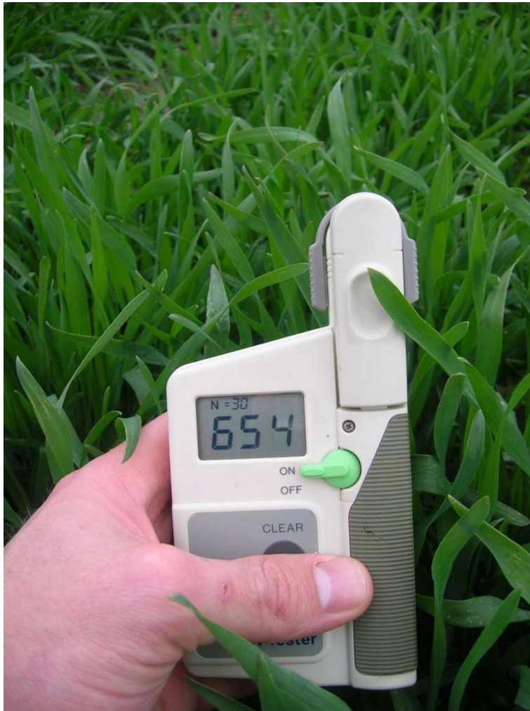
Abb. 2 Der N-Tester misst die Blattfarbe der Getreidepflanzen
