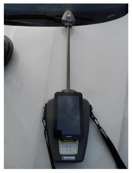
N-Pilot zur Bestimmung von Globalstrahlung (Sensor an der Oberseite in Richtung Himmel), Biomasse und Chlorophyll-Gehalt der Blätter (Sensoren an der Unterseite in Richtung Bestand)
