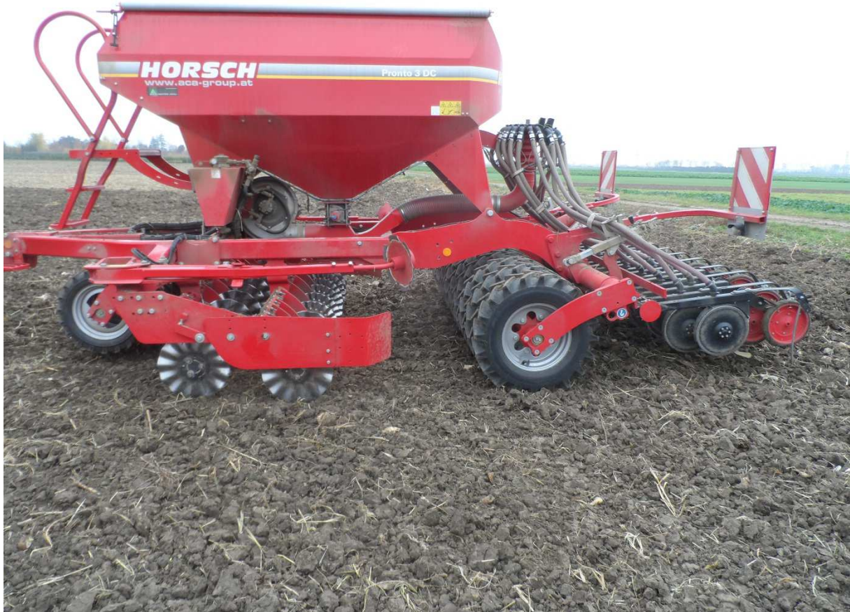
Abb.1: Mulchsaatmaschine mit Zwischenachspacker, Vorwerkzeugen, Reifenpacker, Säscheiben, Andruckrollen und Striegel
