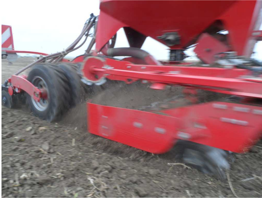
Abb.7: Saat mit Vorwerkzeug Coulterscheibe in das unbearbeitete Feld – bei hoher Fahrgeschwindigkeit wird auch viel Erde hochgeworfen
