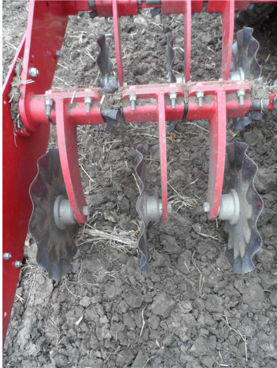
Abb.2: Coulterscheiben als Vorwerkzeug arbeiten nicht ganzflächig, sondern sollen nur Feinerde erzeugen, damit nach den Säscheiben der Saatschlitz wieder geschlossen werden kann. Dies ist für den Bodenschutz vorteilhaft.
