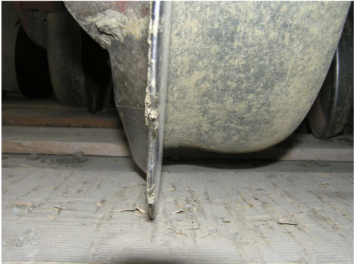
Abb.2: Eingriffstiefe der Schneidscheibe, im Hintergrund: Andruckrolle Aufnahme vom 23.4. 2013
