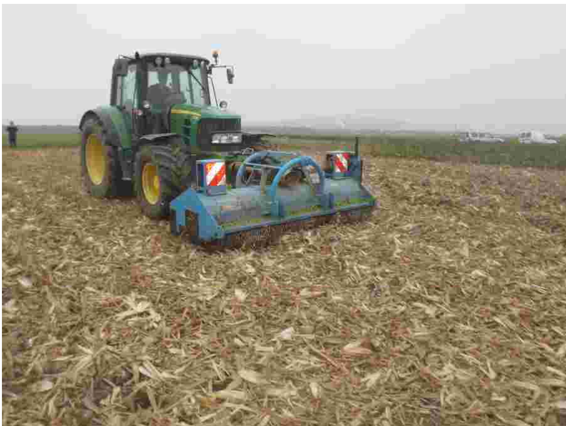
Abb.8: Häcksler mit Y-Messern (beim Einsatz im Maisstroh) Bei der oberflächlichen Betrachtung der Arbeitsqualität zeigten sich wenige Unterschiede.
