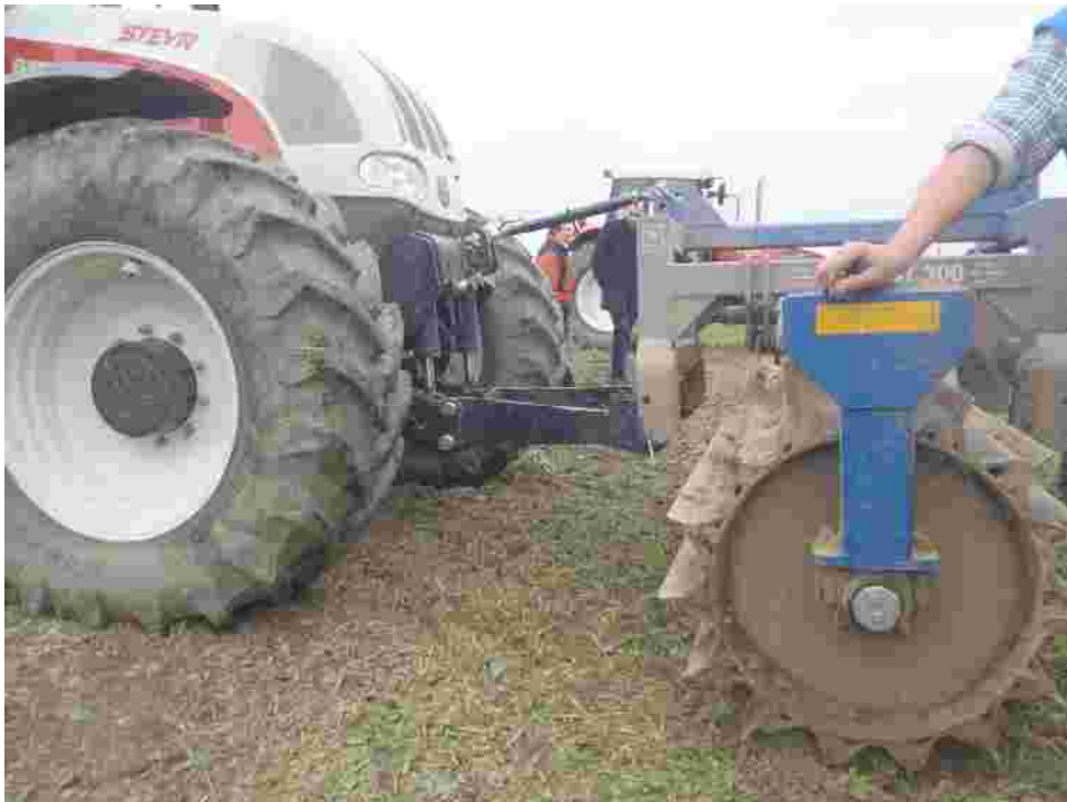
Abb.3: Zweite Messerwalze mit geraden Messern, Selbstlenkung, hohem Eigengewicht
