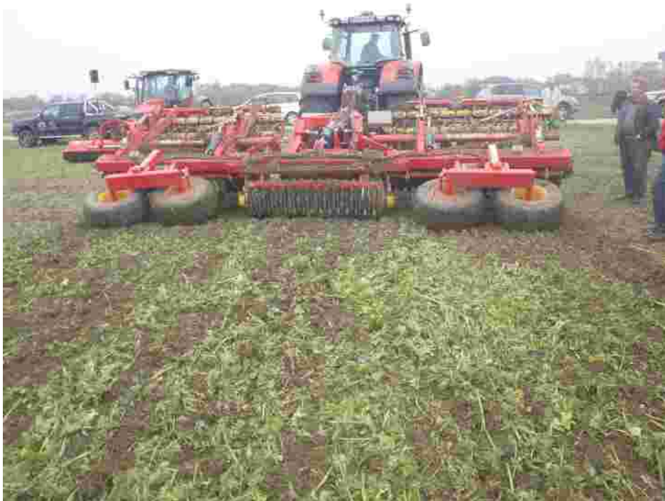
Abb.6: Arbeitsbild des dritten Walzentyps (mit Bodenbearbeitung kombiniert)
