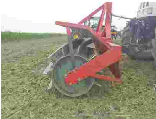
Abb.1: Erste Messerwalze mit spiralförmig angeordneten Messern und Schutzblech
