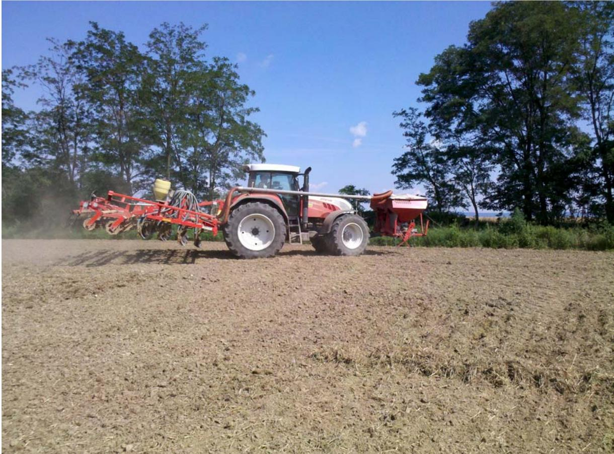
Abb.3: Zinkensaat mit Frontsätank und Leichtgrubber
