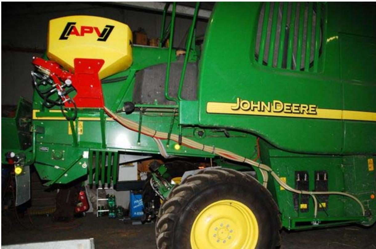
Abb.1: Hydraulisch angetriebenes und elektrisch gesteuertes Säaggregat
