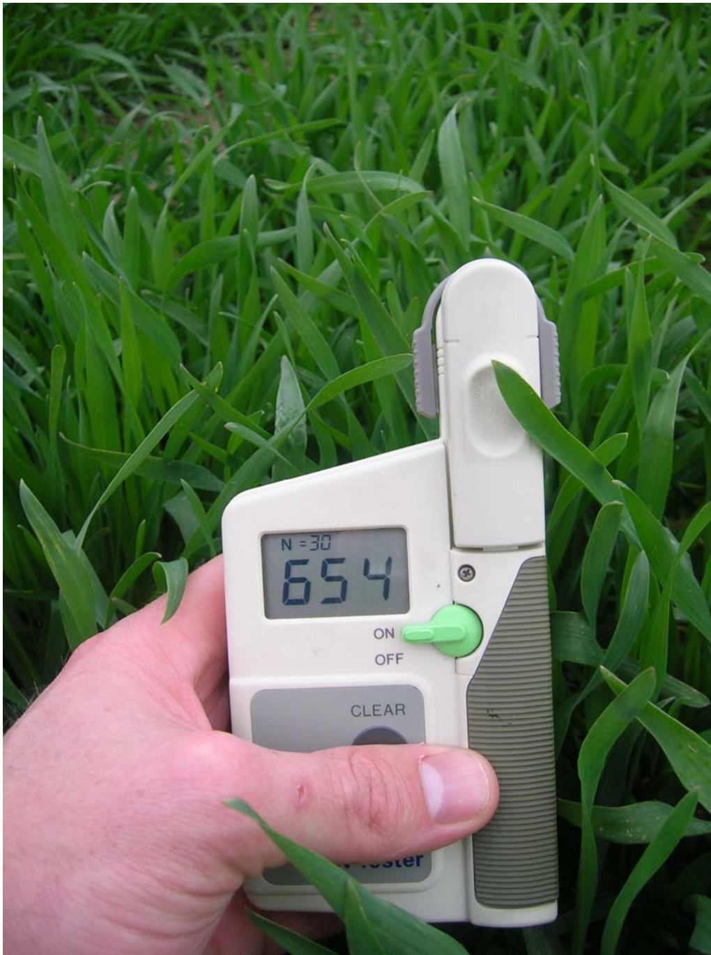
Abb. 1 Der N-Tester misst die Blattfarbe der Getreidepflanzen
