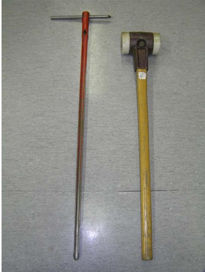
Abb. 2: Bodenbohrer zur Probenahme bis maximal 90 cm Bodentiefe
