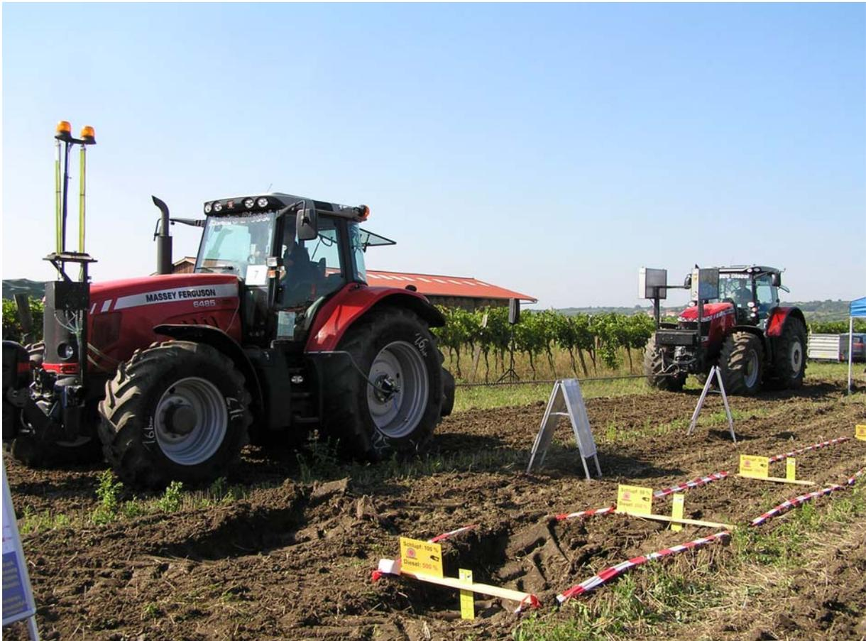
*Abb. 1: Ein Zugtraktor mit Verbrauchsmessung zieht einen Traktor, der gebremst wird*
