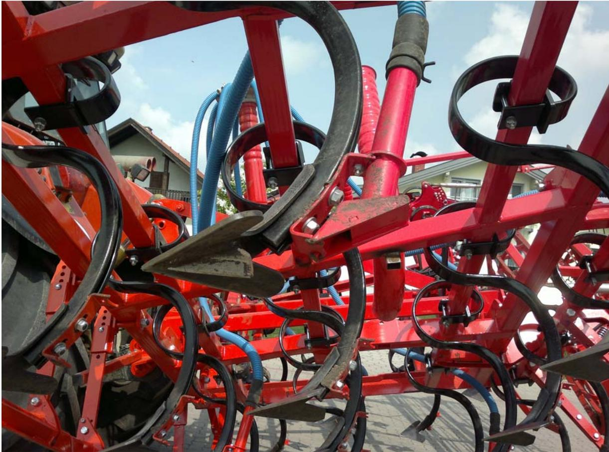
*Abb. 3: Saatrohre mit enger Saatgutablage für z.B. Mais*
