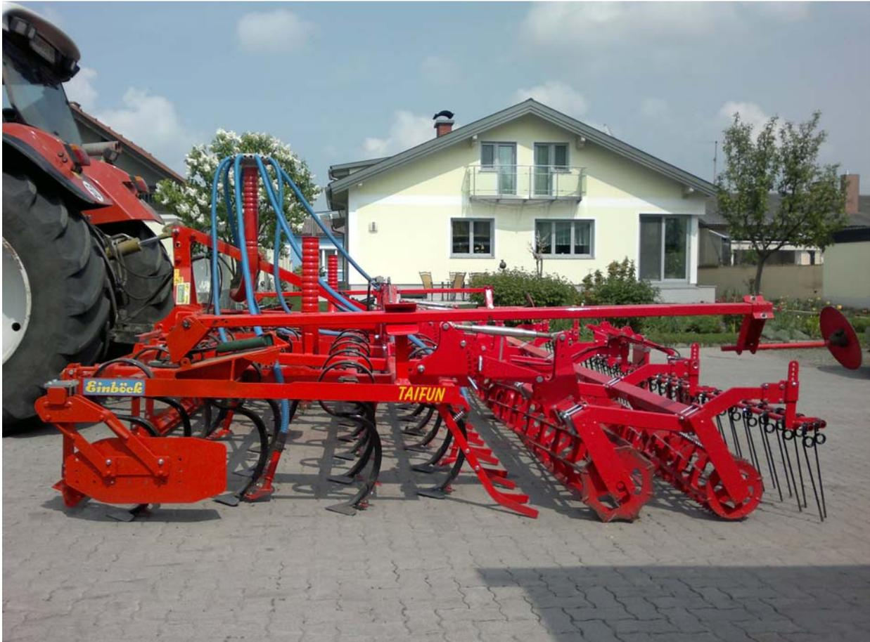
*Abb.2 Zentraler Verteiler für den Anbau von Hackkulturen, Eigenbau Spurreißer in eingeklapptem Zustand*
