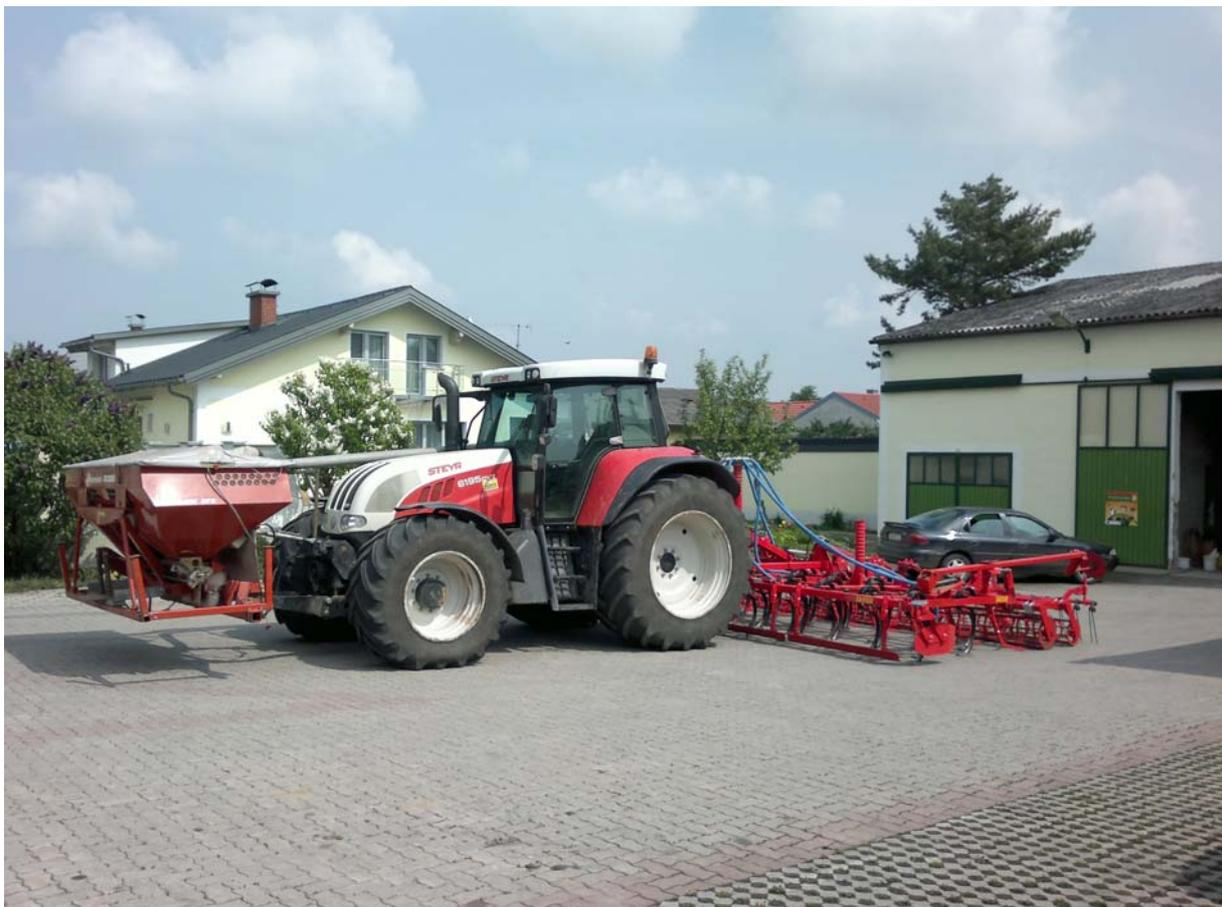
*Abb. 1: Mulchsaatkombination der Fam Leeb, Baumgarten. Frontsätank mit Doppel-Dosiereinrichtung, pneumatischer Saatgutbeförderung nach hinten, Leichtgrubber mit Zinkensaateinrichtung*
