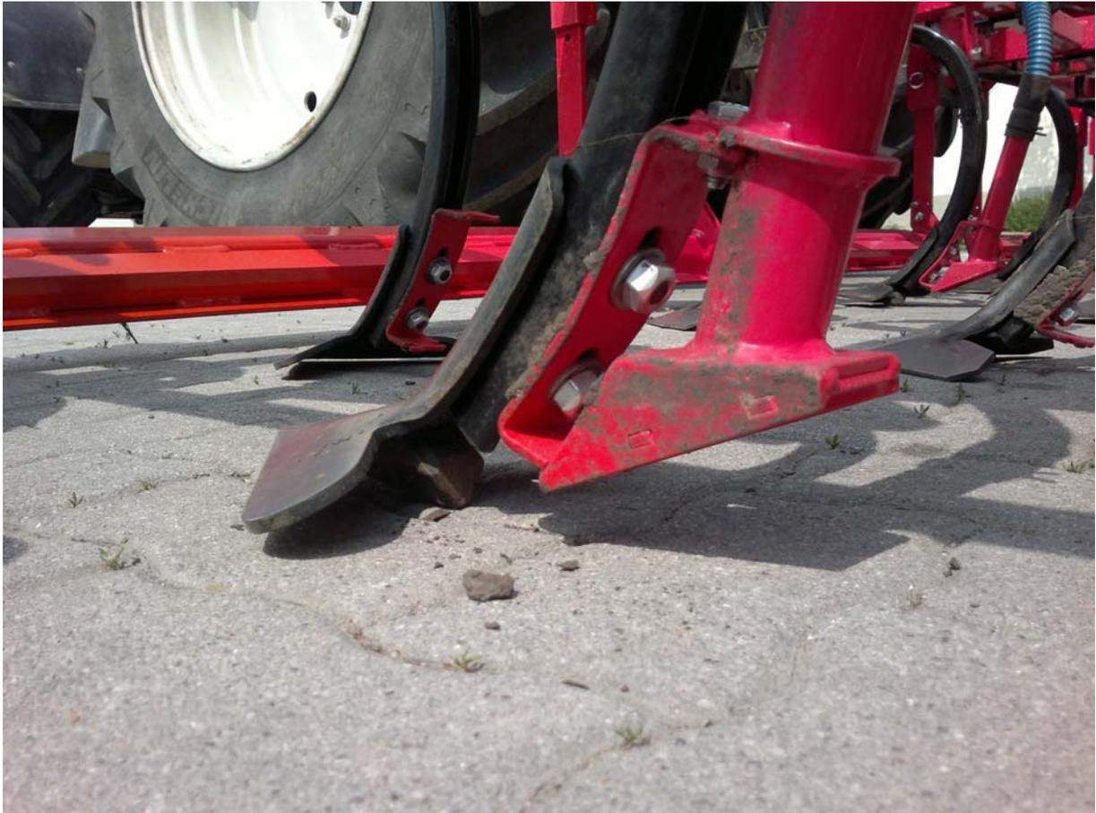
*Abb.4: Saatrillenformer für eine verbesserte Reihen- und Tiefenablage*
