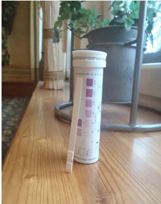
Abb. 5: Messstreifen und Skala Das außenliegende (im obigen Bild das untere) Messfeld verfärbt sich umso dunkler, je höher der Nitrat (NO 3 -) Gehalt ist.
