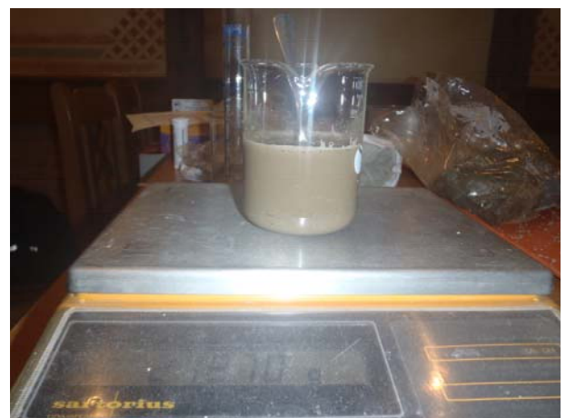
Abb. 2: Umrühren von 100 g Boden und 100 ml Wasser, bis der Boden vollständig aufgeschlämmt ist.
