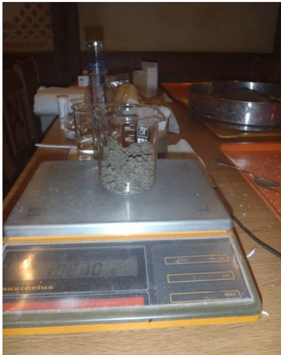
Abb. 1 Abwiegen von 100 g Boden in einem Gefäß. Im Hintergrund ein Sieb zum Absieben von Grobanteilen (Steine)
