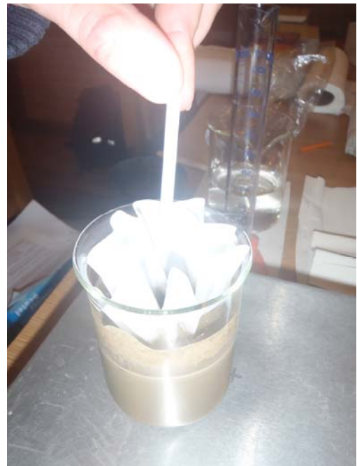
Abb.4 Eintauchen des Teststreifens in die klare Flüssigkeit für 1 Sekunde, Teststreifen abschütteln und 1 Minute warten
