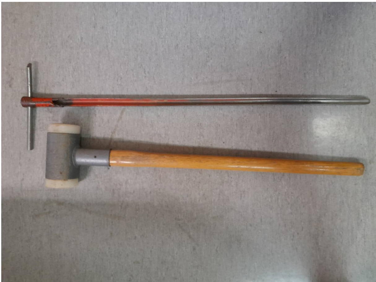
Bodenbohrer zur händischen Entnahme von Bodenproben bis 90 cm Tiefe
