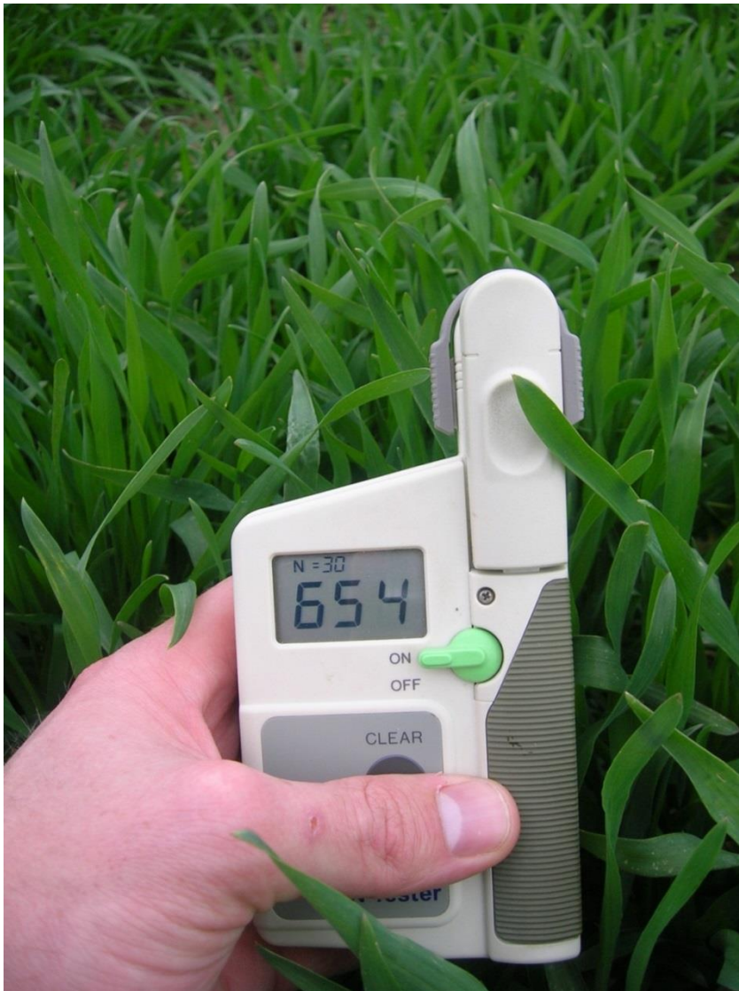
Abb. 1 Der N-Tester misst die Blattfarbe der Getreidepflanzen
