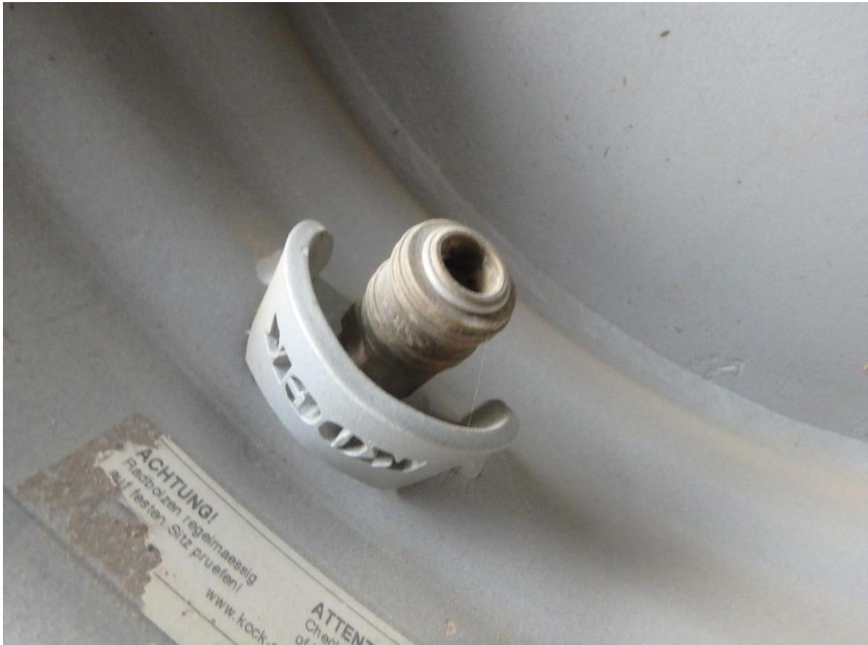
Schnellfüllventile ermöglichen eine rasche Anpassung des Reifenfülldrucks
