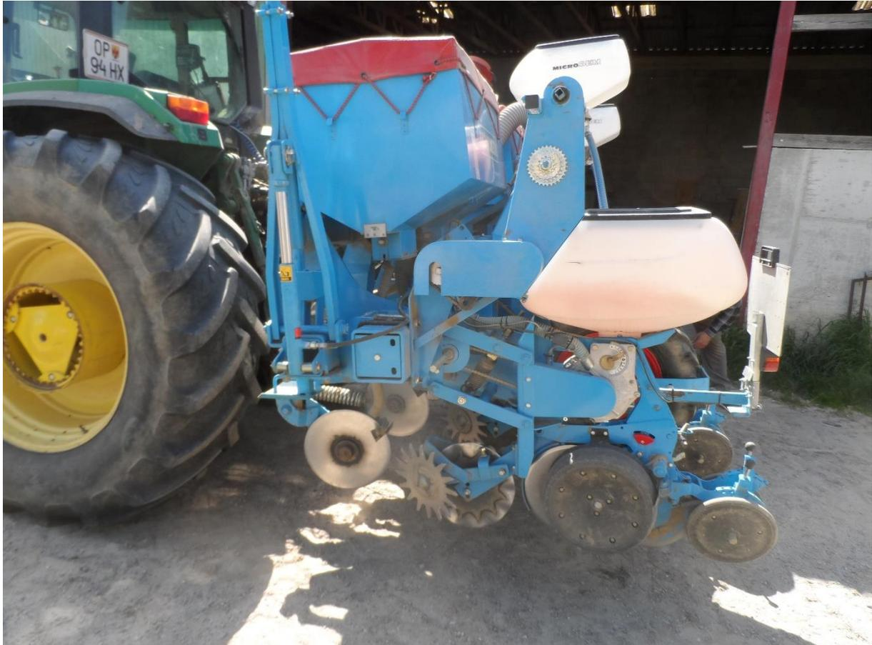
Sämaschine mit Sternräumern, Coulterscheiben, Doppelscheiben-Säscharen und Andruckrollen
