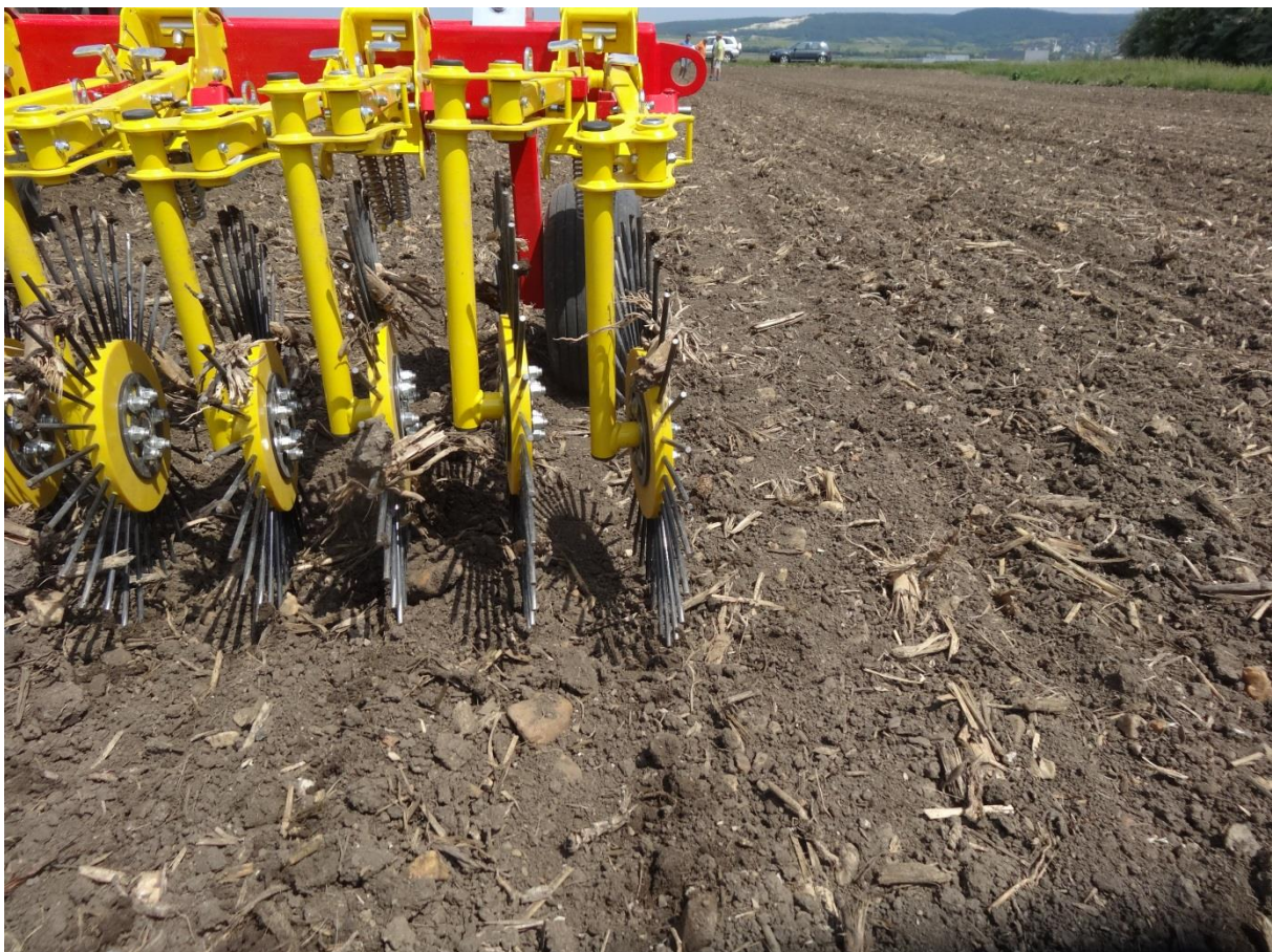
Abb.: Einsatz der Rollhacke zum Blindstriegeln in Soja bei pflugloser Bearbeitung der Mais-Vorfrucht-Stoppel
