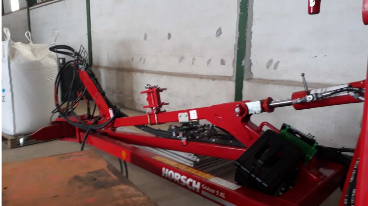
Abb.6: Zugkraftverstärker zur Übertragung von Lasten vom Gerät auf die Traktor-Hinterachse
