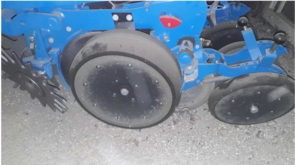
Abb.2: Einzelkorn-Sämaschine mit Sternrad-Klutenräumer, Scheibenschar, Tiefenführungsrolle, Zwischendruckrolle, Andruckrolle
