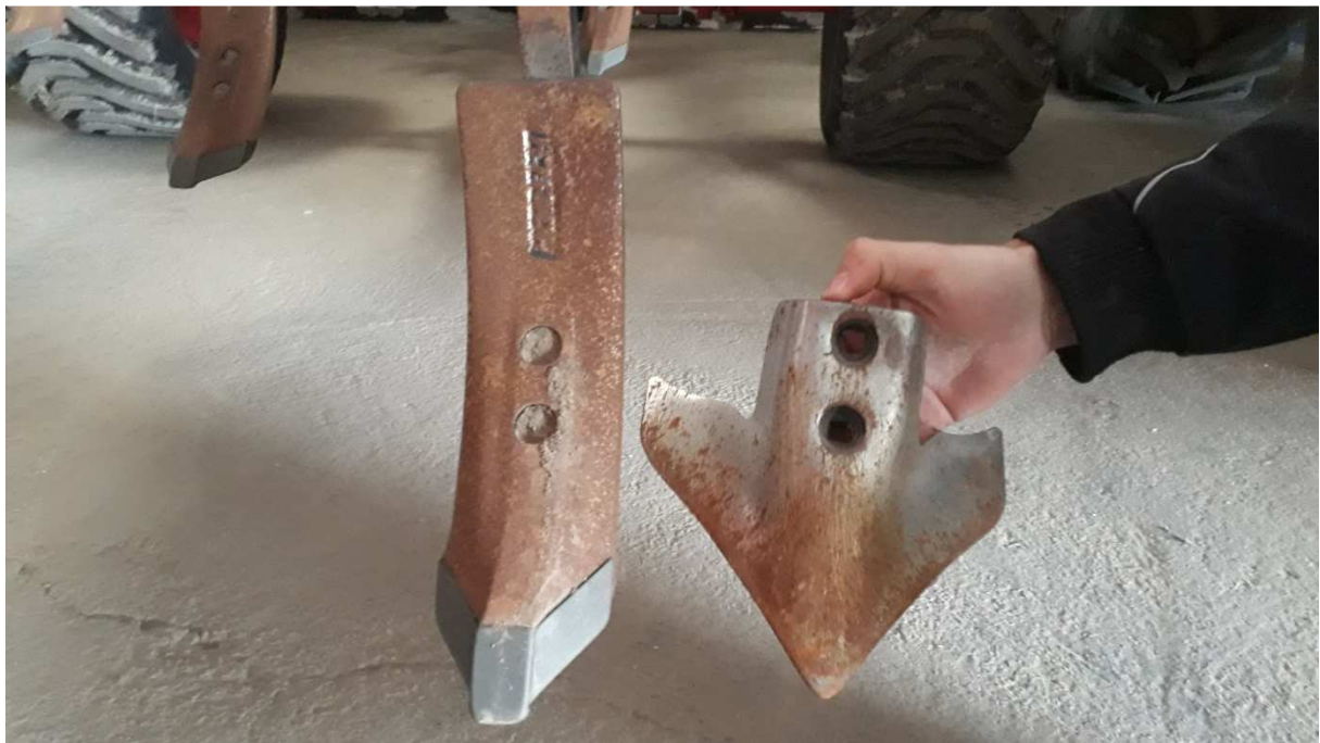
Abb.5: Einsatz von Gänsefußscharen für ein flaches, ganzflächiges Durchschneiden
