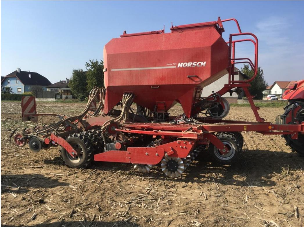
Abb.1: Mulchsaatmaschine mit Vorwerkzeugen
