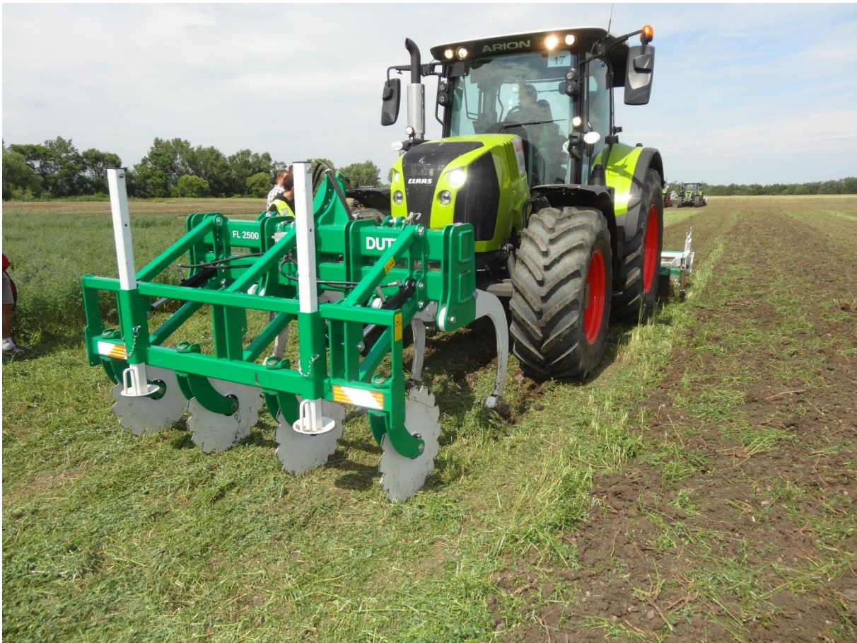
Abb.6: Zinken lockern den Bereich vor der Traktorspur
