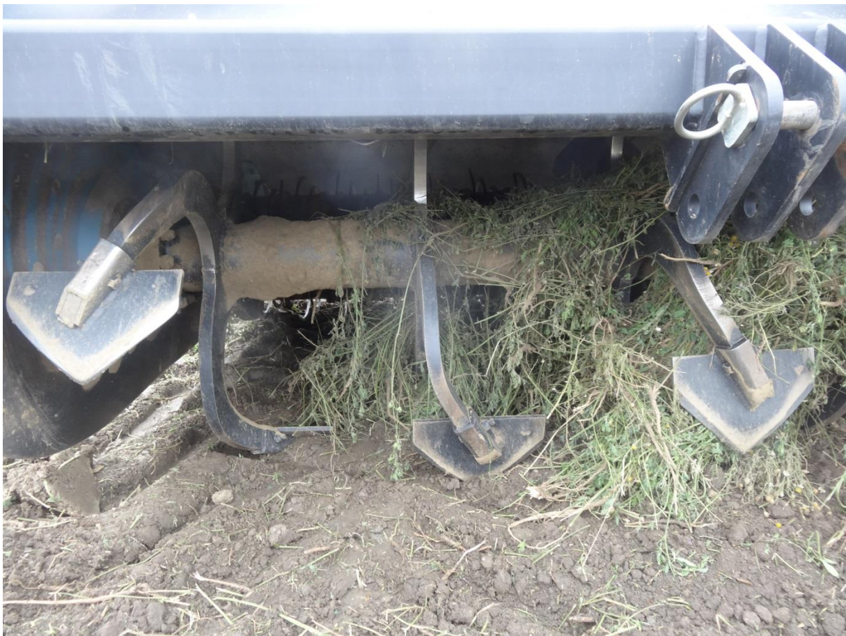
Abb.2: Spatenblätter auf einem Rotor angeordnet, Verstopfung des Rotors durch zu hohe Fahrgeschwindigkeit im stehenden Bestand
