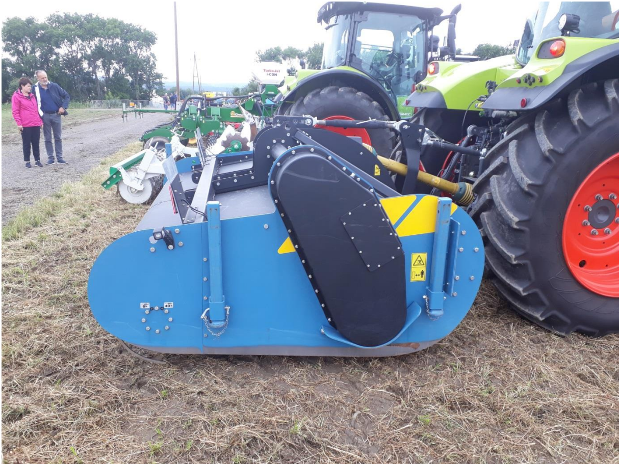
Abb.1: Spatenmaschine Imants 38SX300H
