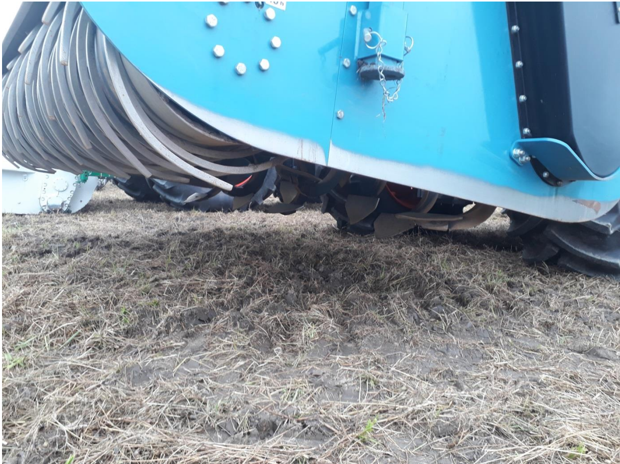
Abb.3: Aktiv angetriebene Walze zur Rückverdichtung, Zerkleinerung der Oberfläche und Tiefenführung
